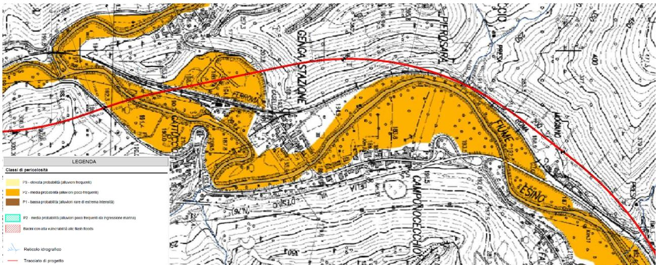
Fig. 2 – Lotto 2: pericolosità idraulica da P.G.R.A. (2019), tra progr. 0+600 e progr. 3+400.
