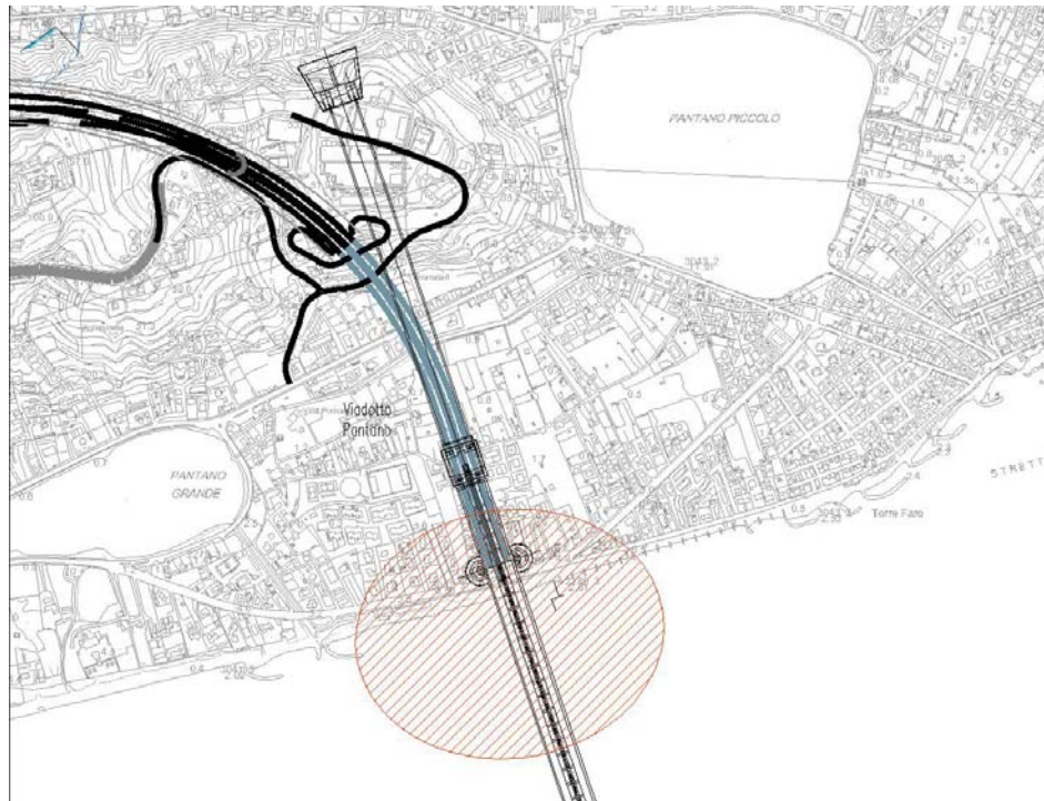
Figura 11.3. Area di possibile evoluzione del cuneo salino – zona fondazioni delle torri.
