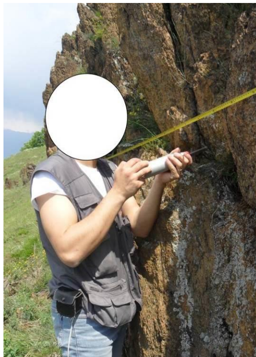
Figura 6. Misura del rimbalzo del martello di Schmidt.
