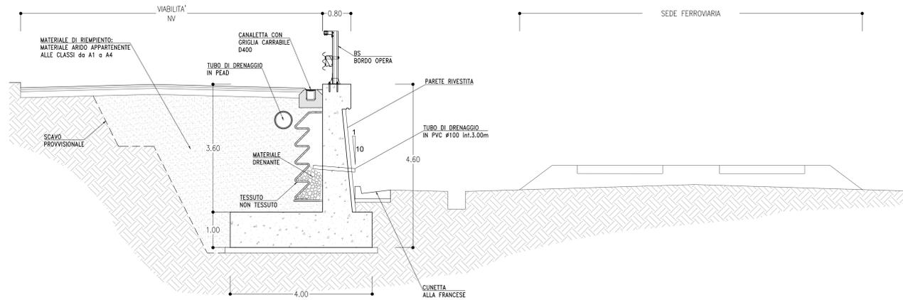
**MURO DI SOSTEGNO TIPO TM-C1, TM-C2**
