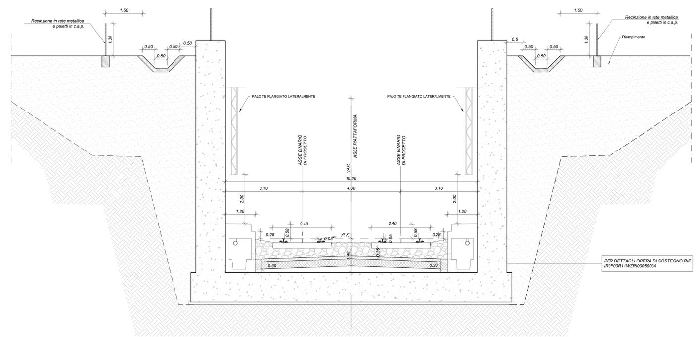
SEZIONE TIPO IN TRINCEA CON SCAVO IN ROCCIA
