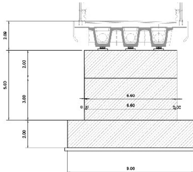
Fig. 5 – NW01: Sezione su pila
