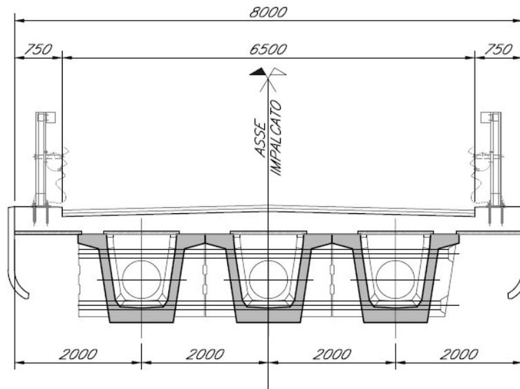
Fig. 2 – NW01: sezione trasversale
