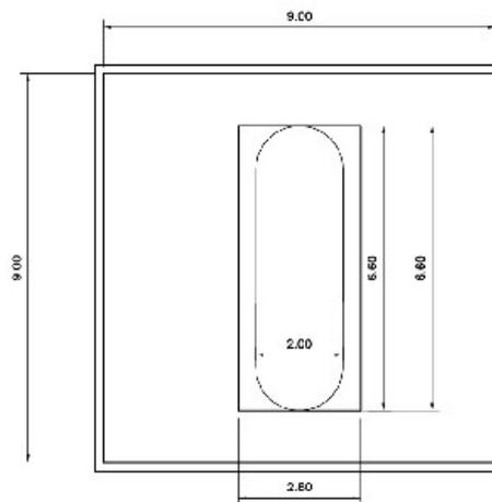
Fig. 6 – NW01: Plinto fondazione diretta
