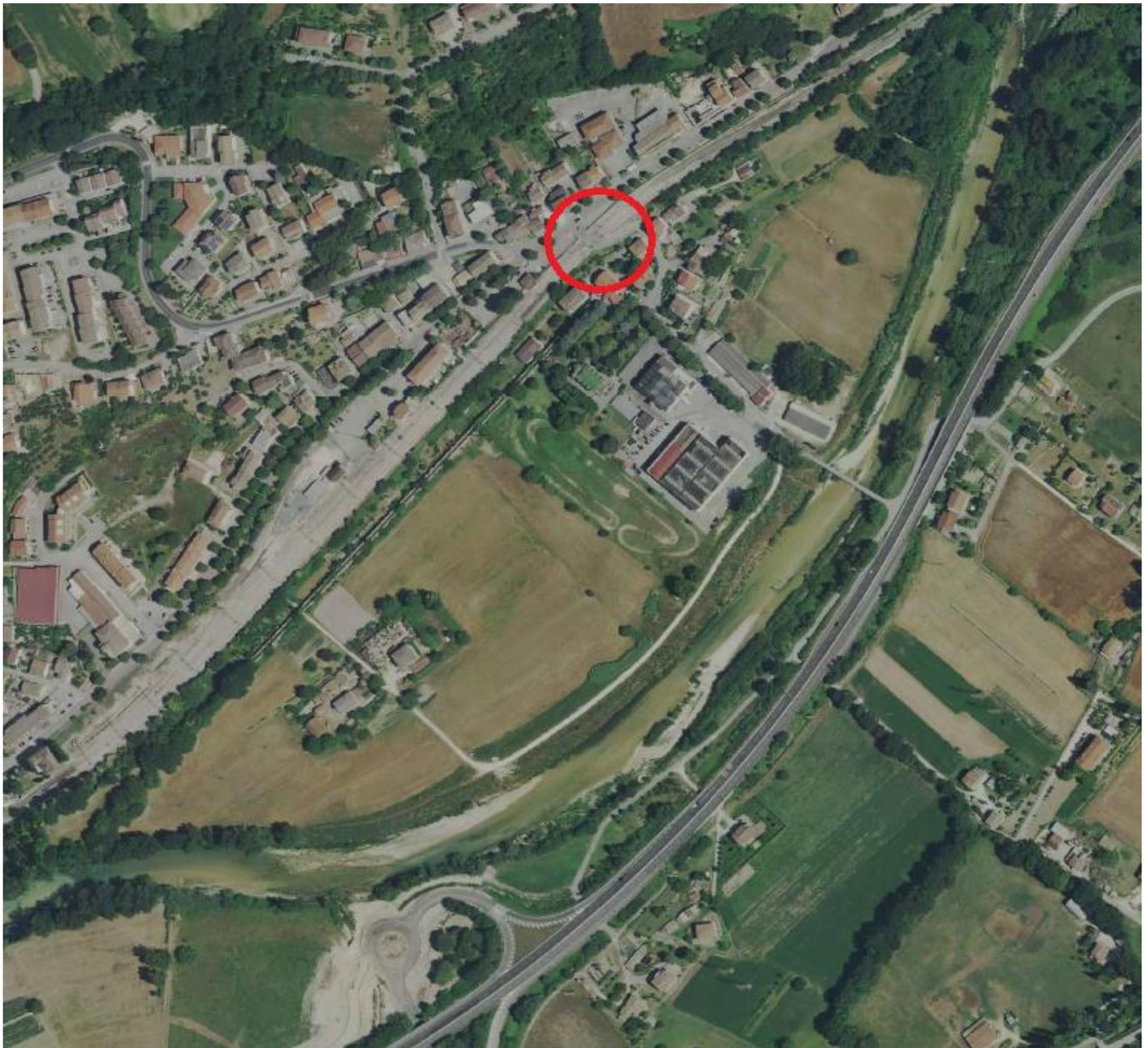
La viabilità esistente nell'intorno del passaggio a livello ha larghezza limitata anche a soli ca. 6 m, e curve con raggi piccoli, anche di soli 10 m (questo tratto viene completamente aggirato dalla nuova viabilità di progetto).
