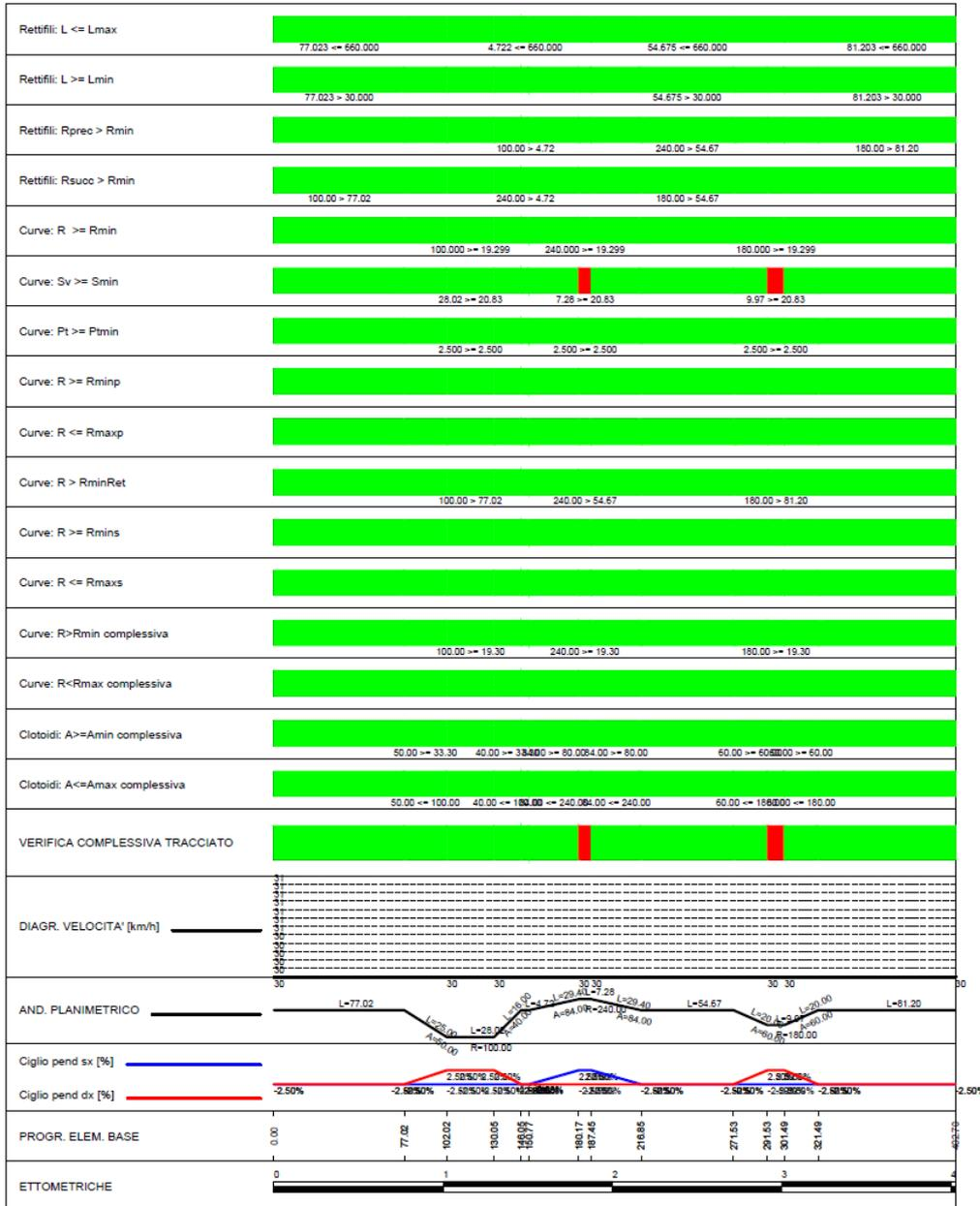
Si evidenzia che le criticità riguardano solamente lo sviluppo delle curve, cioè criteri riguardanti la percezione ottica del tracciato. Le criticità sono dovute al vincolo di seguire la viabilità esistente.
