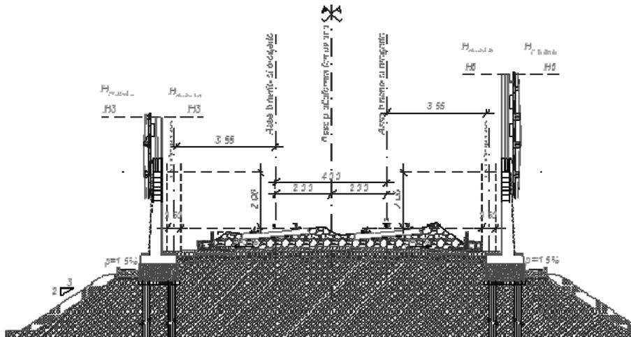
Figura 29 - Sezione tipo tipologico BA "HS" rettificato da rilevato
