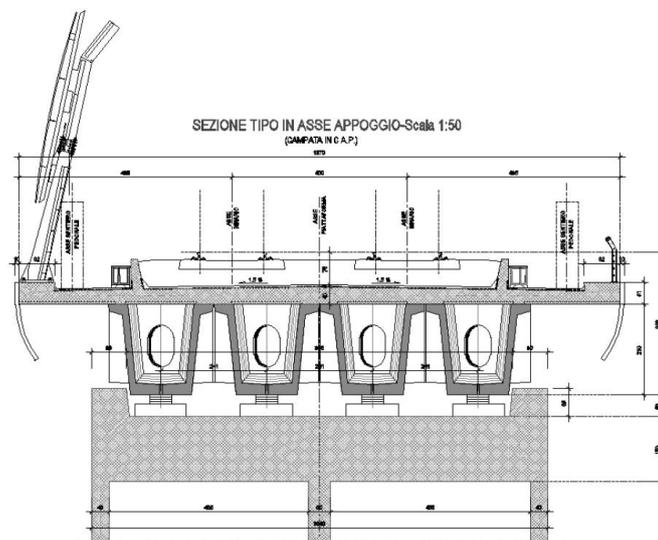
**Figura 7 - Sezione tipologica campata da 25m**
