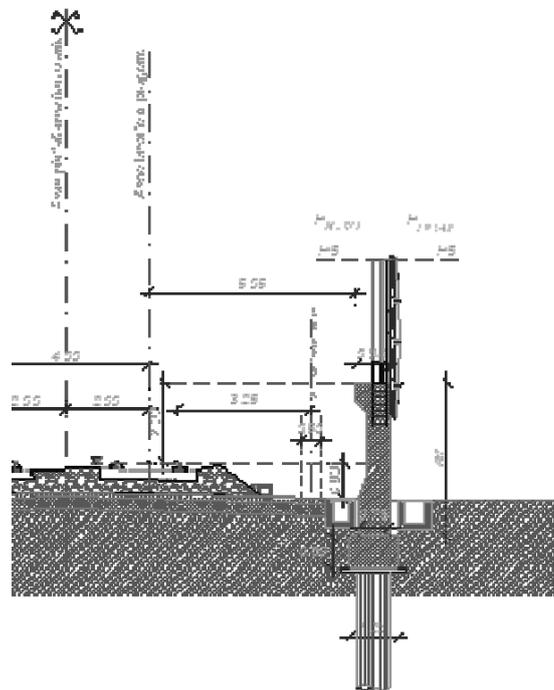
Figura 30 - Sezione tipo tipologico BA "HS" rettificato su opera di sostegno
