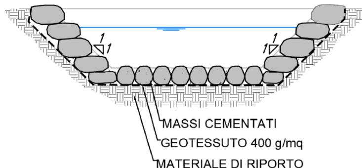
**Figura 24 – Sezione tipologica risagomatura canale trapezio con massi cementati**
