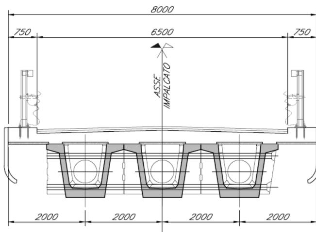
**Figura 26 - NW01 Sezione trasversale**
