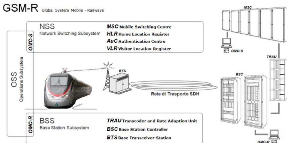
**Figura 34 - Architettura del Sistema GSM-R**
