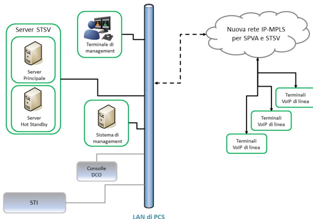
**Figura 35 - Architettura Sistema Telefonia Selettiva STSV**
