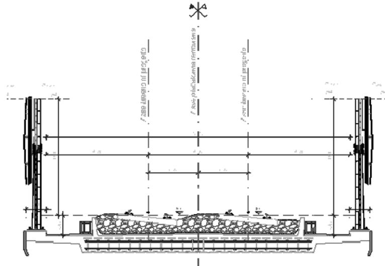
Figura 31 - Sezione tipo tipologica BA "HS" rettificato da impalcato ferroviario
