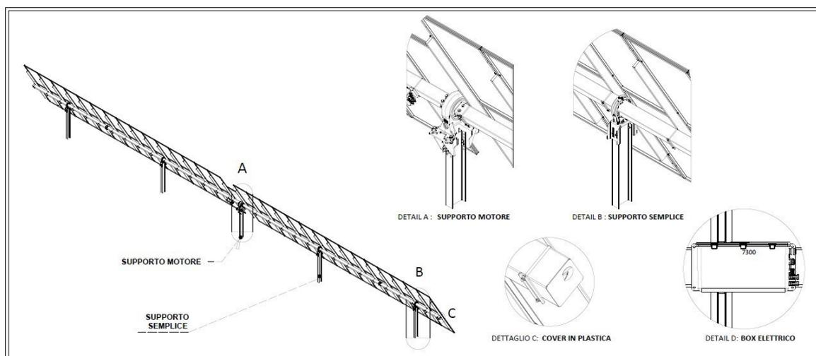
Figura 11 - Particolari costruttivi degli inseguitori installati
