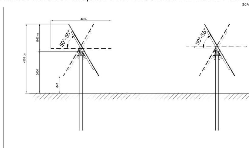
Figura 9 - Profilo longitudinale struttura
