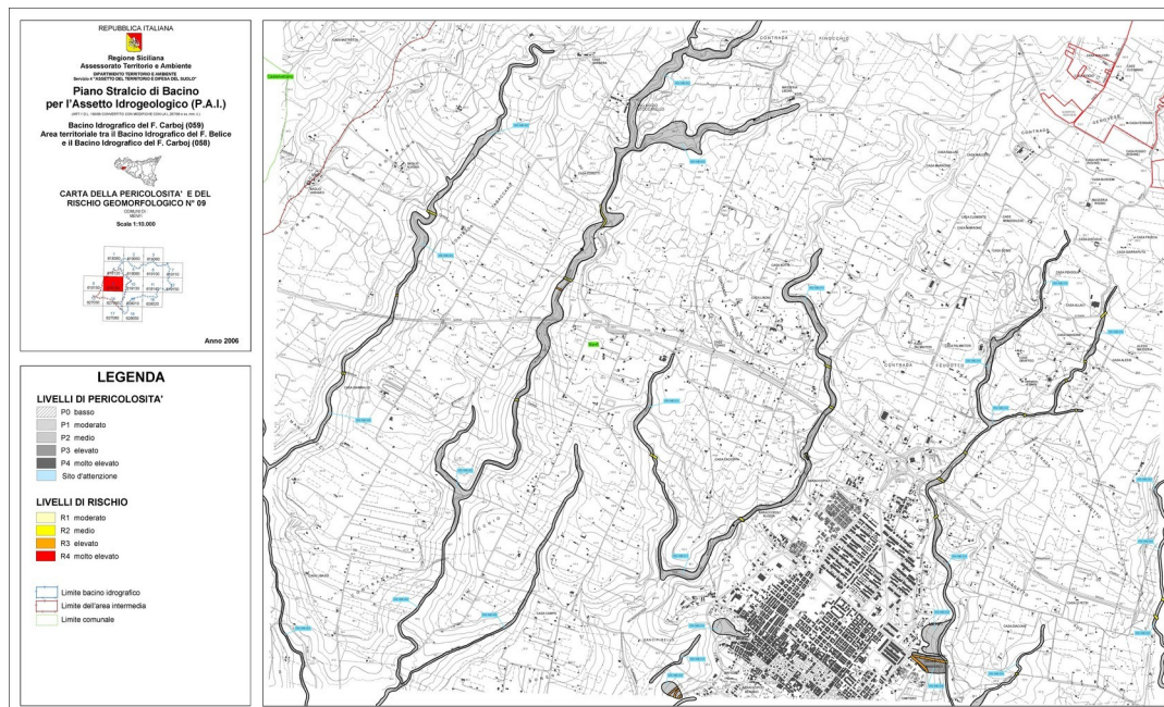
Figura 19 - Carta della pericolosità e del rischio geomorfologico dell'area d'impianto ricadente nel territorio di Menfi (AG- località Genovese) [Fonte Regione Sicilia P.A.I.]
