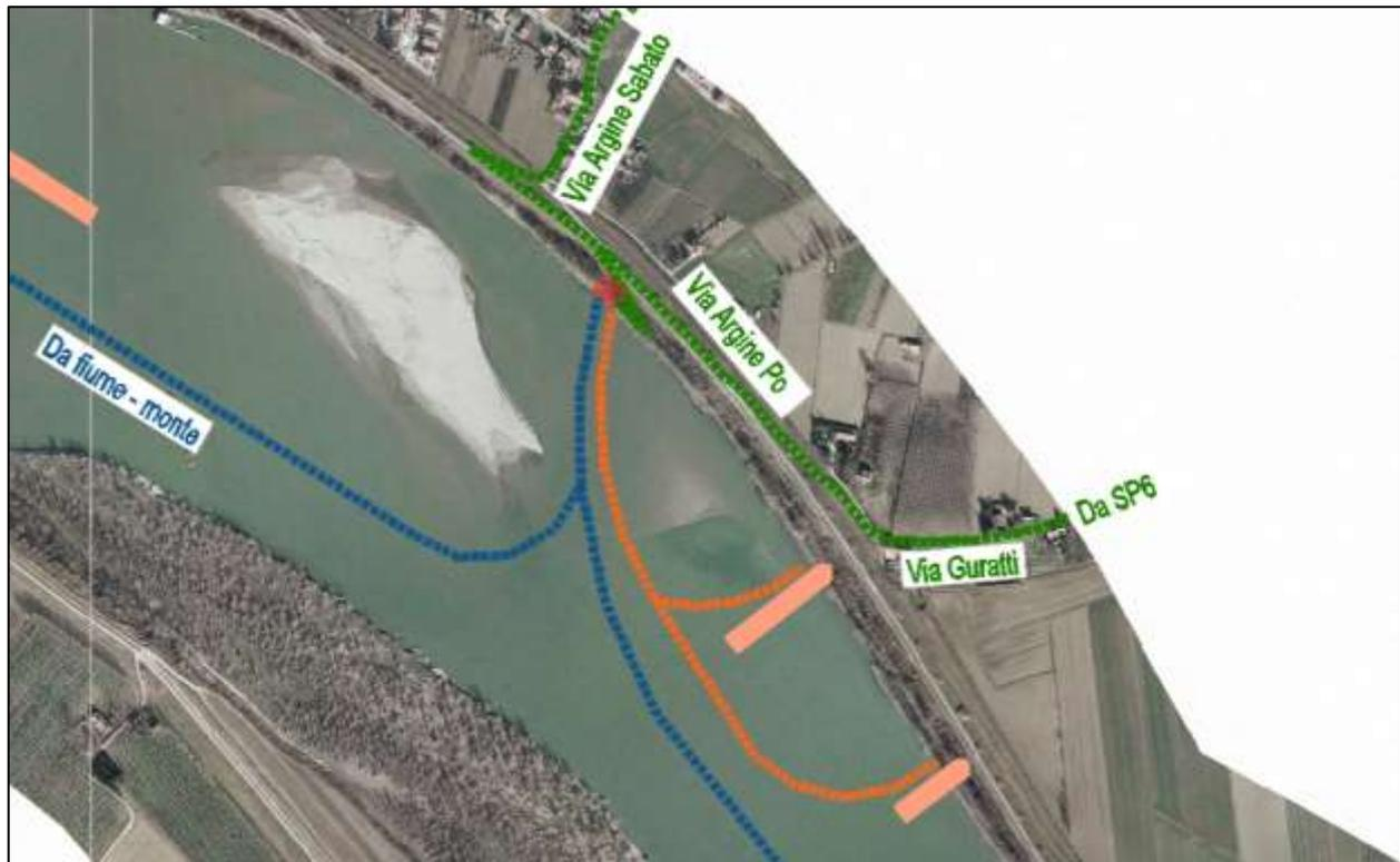
Figura 21 - Planimetria degli accessi all'area di cantiere INTERVENTO 14
