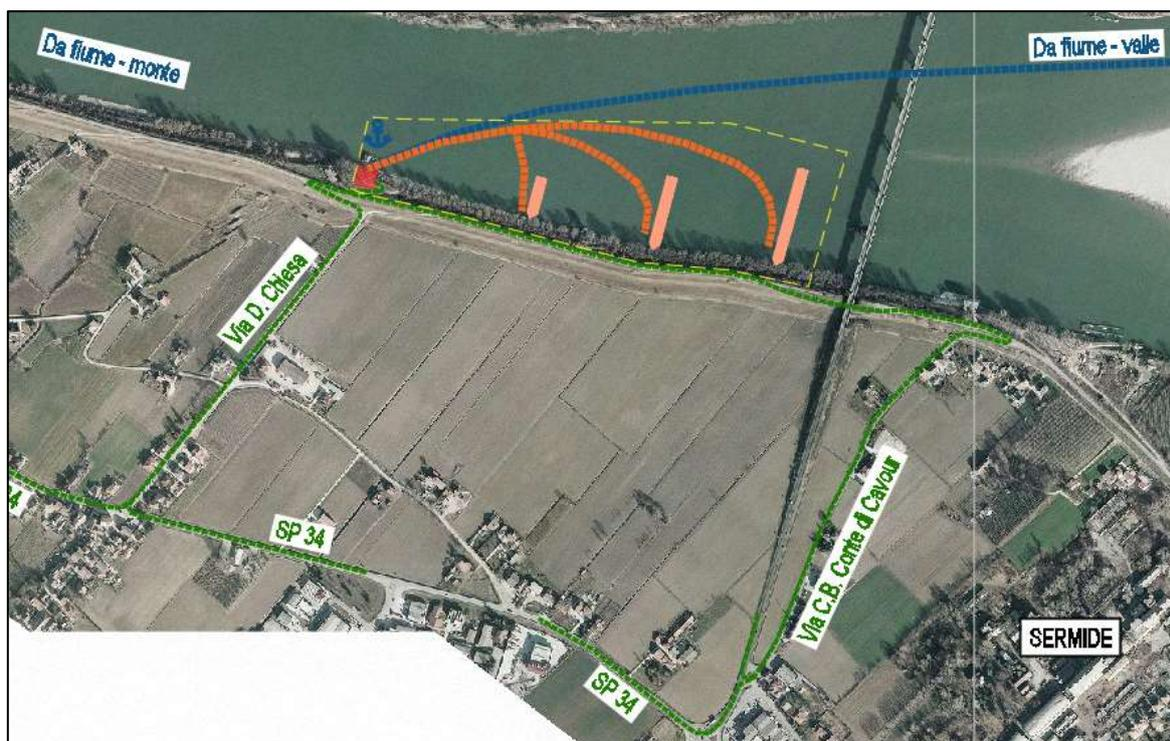
Figura 7 - Planimetria degli accessi all'area di cantiere INTERVENTO 1 (percorsi fornitori via fiume in blu, percorsi fornitori con automezzi in verde e percorsi di cantiere per pontone in arancione)
