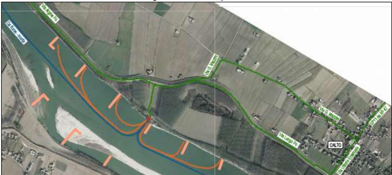
Figura 9 - Planimetria degli accessi all'area di cantiere INTERVENTO 3 in sponda destra
