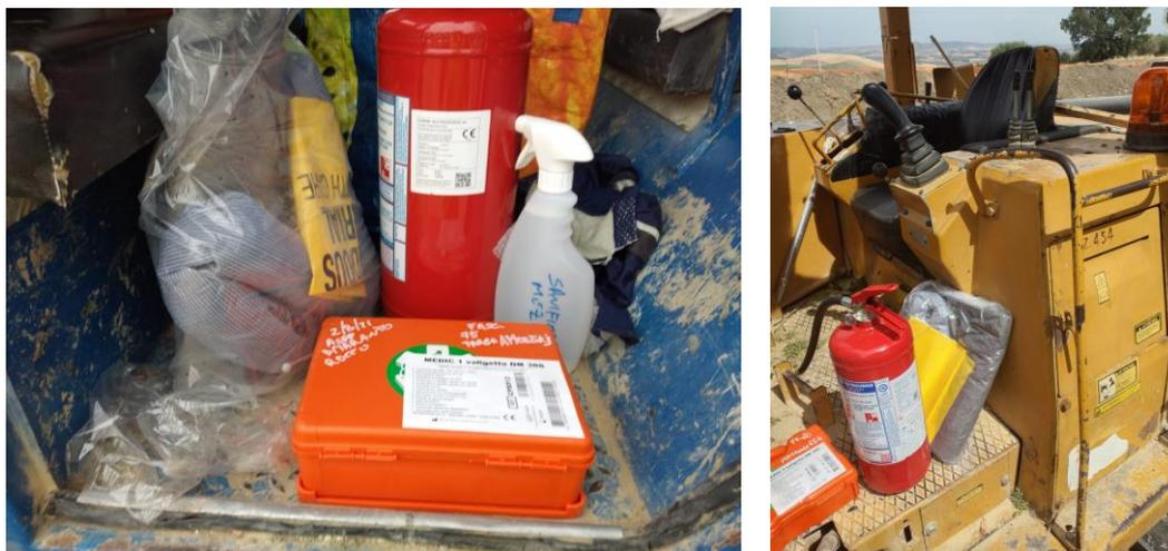
Fig. 4 – Spill-kit in dotazione ai mezzi di lavoro
