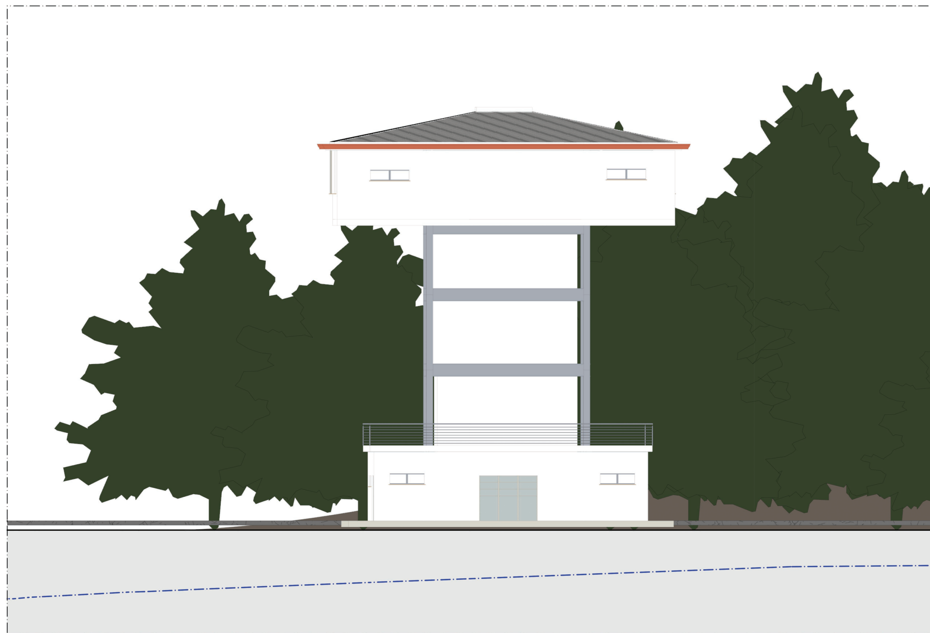
PROSPETTO NORD-EST TORRE DI CONTROLLO SCALA 1:100
