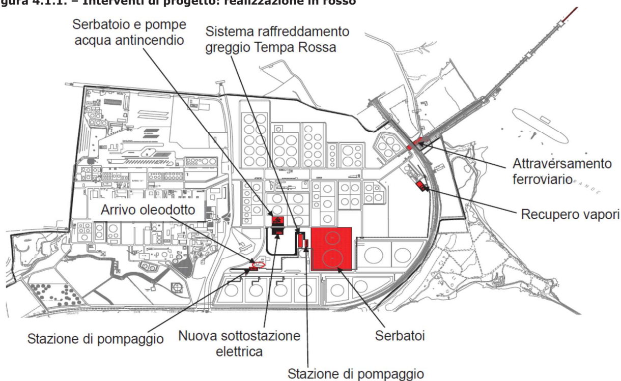
Figura 4.1.1. – Interventi di progetto: realizzazione in rosso
