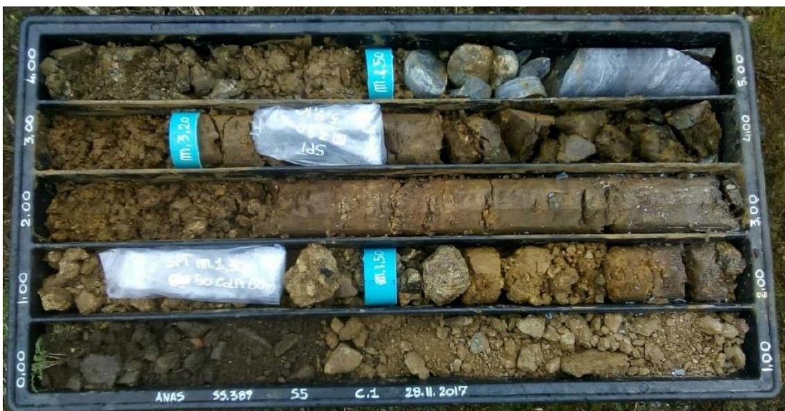
Figura 3 - Coltre superficiale dello scisto molto alterato.
