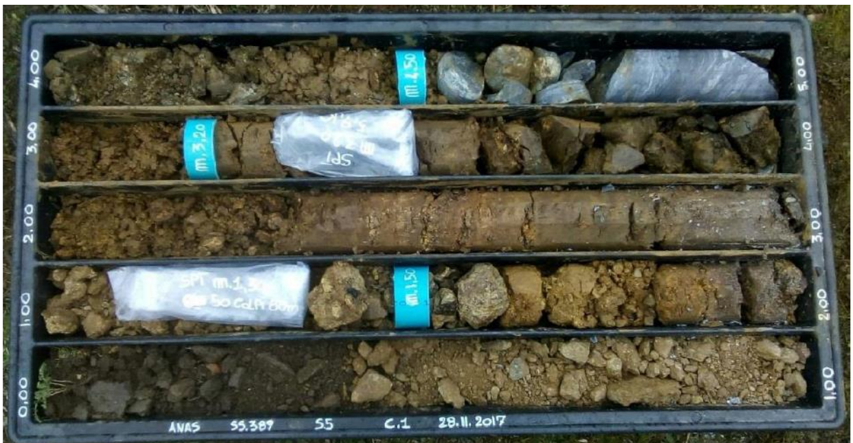
Figura 5.2. Coltre superficiale dello scisto molto alterato.
