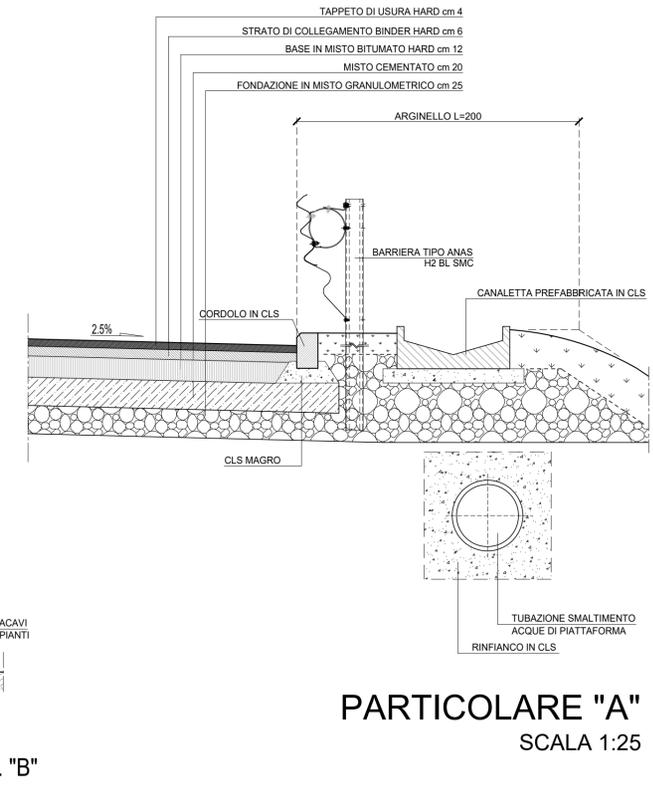
SEZIONE TIPO IN RILEVATO
