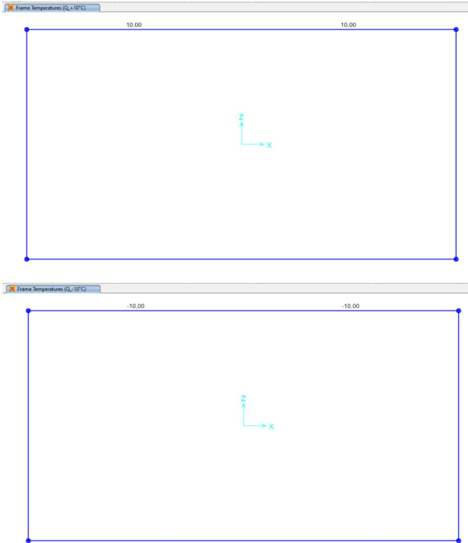
Figura 19- Carico termico stagionale  $\pm 10^{\circ}\text{C}$
