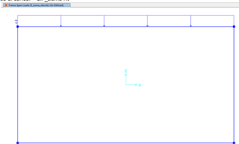
Figura 19- Carico sismico del terreno di ritombamento
