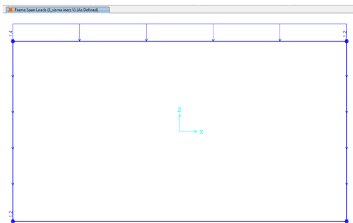
Figura 22- Carico sismico inerziale in direzione verticale
