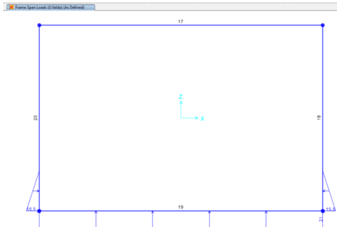
Figura 10- Carico dell'acqua per la sezione tipo 1
