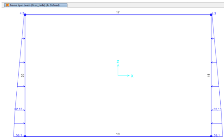
Figura 8- Spinta statica del terreno
