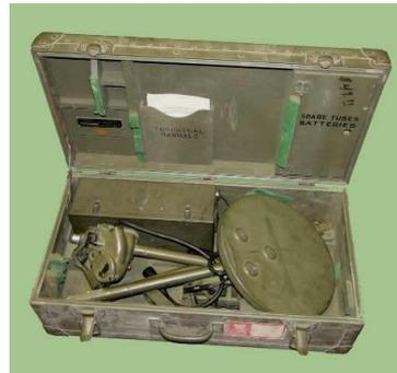
apparati di profondità, quelli fabbricati dall' Istituto Forster di Reutlingen (Germania) o similari, purché ritenuti idonei dalla direzione dei lavori, in grado di rivelare o localizzare, di massima, masse ed ordigni ferrosi inglobati in terreni scevri da sostanze ferrosi», fino alla profondità di almeno cm. 100.
