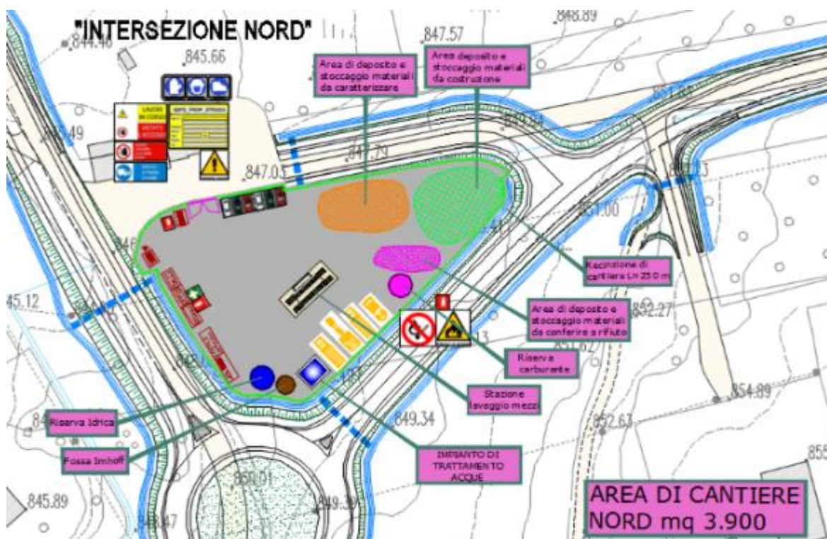
Figura 16- Area cantiere nord
