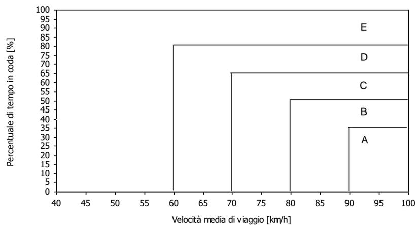
Valori limite per le zone di LOS (*Highway Capacity Manual*)
