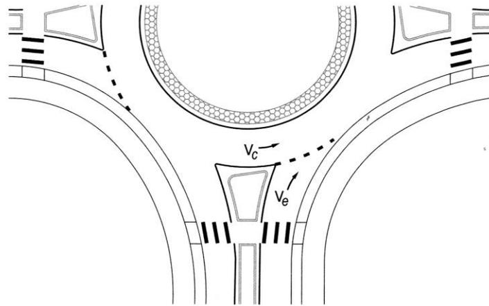
Capacità d'ingresso del braccio di una rotatoria (FONTE: Highway Capacity Manual 2010)
