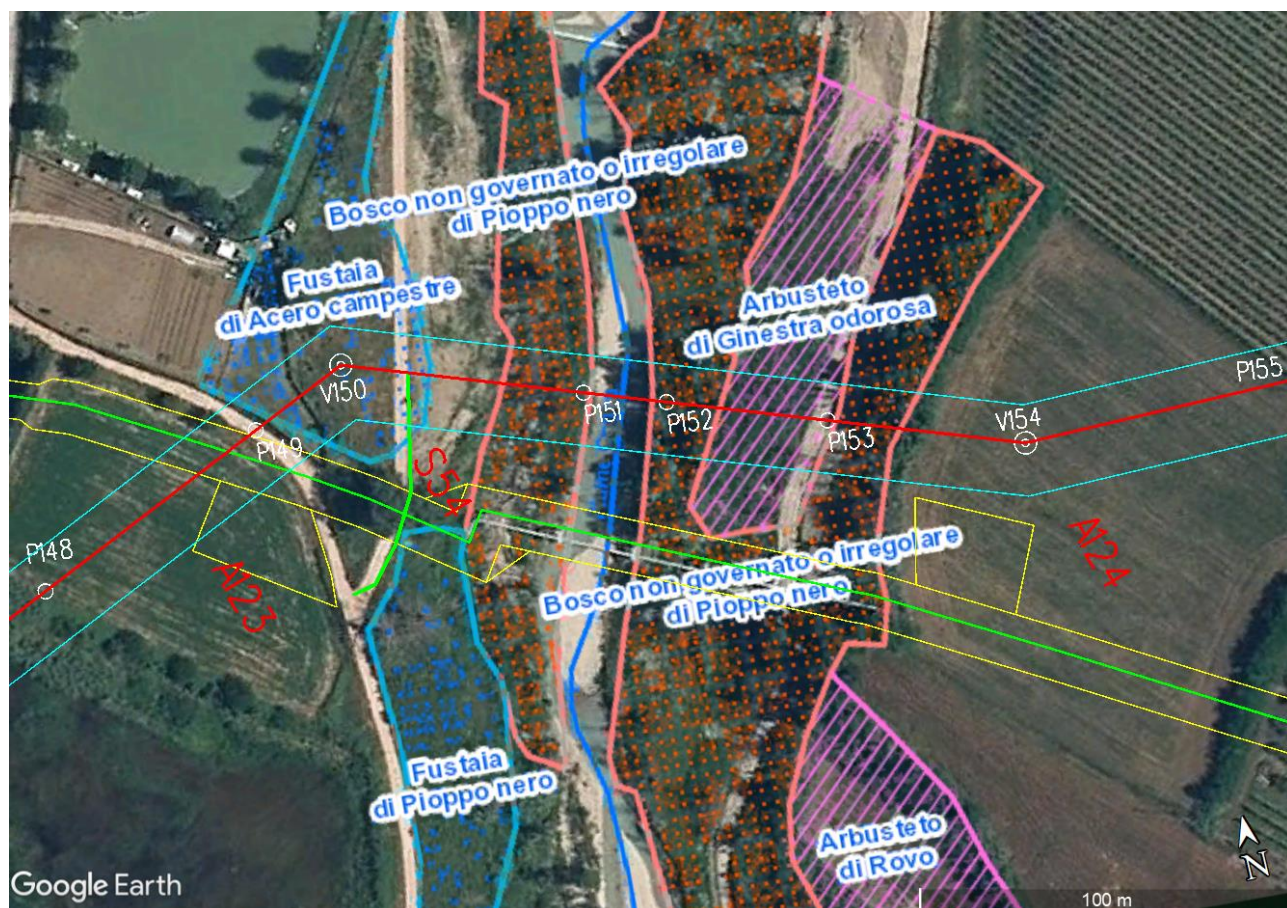
Figura 4.16. Stralcio di CTR e carta tematica regionale (aggiornata al 2014) con evidenziate le tipologie forestali del bosco sulle sponde del Torrente Conca (in rosso la linea in progetto e in verde la linea in dismissione).
