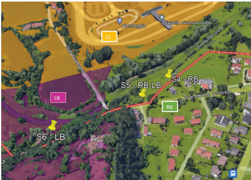
Figura 6: Ubicazione sondaggi S4, S5, S6 rispetto alle unità deposizionali.
