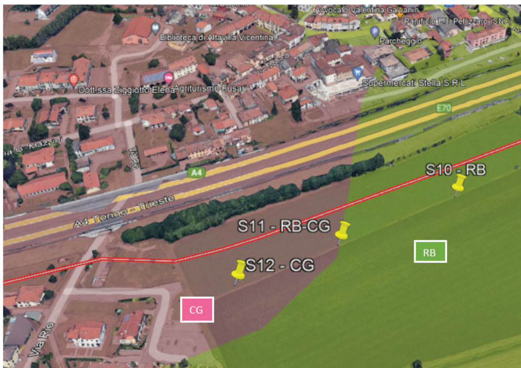
Figura 8: Ubicazione sondaggi S10, S11, S12 rispetto alle unità deposizionali.
