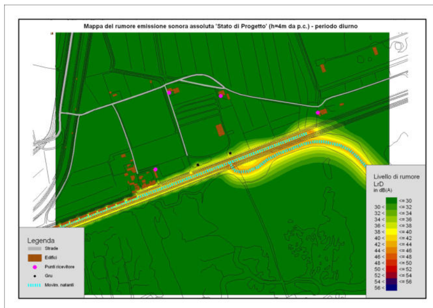
Figura 70. Mappa della propagazione dell'emissione sonora delle sorgenti nella fase di esercizio (effetto H06.01.01).
