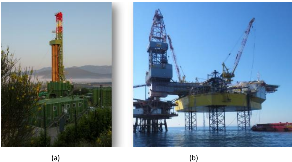
Figura 3.1-6: Esempi di impianto di perforazione a terra (a) e a mare (b) operanti in Italia [Foto DGSUNMIG]. Si osservi che il Jack Up è l'impianto al centro (giallo) e sarà rimosso terminata l'attività; la piattaforma vera e propria è la struttura molto più piccola a sinistra (rossa) sotto la torre di perforazione.
