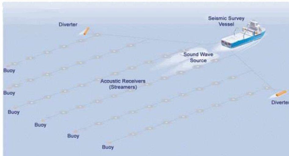
Figura 3.1-3: Schema dell'assetto in mare durante una campagna di raccolta dati geofisici con airgun
