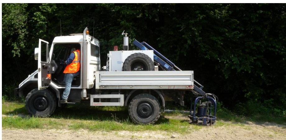
Figura 3.1-5: Mini-Vibroseis usato singolarmente per operazioni geofiche più limitate. La piastra vibrante è alla base della campana premuta a terra dal braccio del mezzo. Il cilindro sopra la piastra ed interno alla gabbia è il dispositivo elettro-idraulico che imprime la vibrazione alla piastra [Foto DGSUNMIG].
