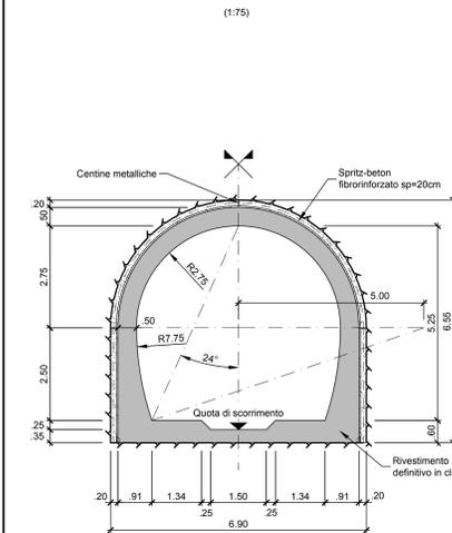
**Sezione tipo 2 Galleria idraulica**
