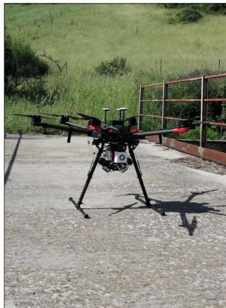
**FASI DI RILIEVO: STRUMENTAZIONE UTILIZZATA PER EFFETTUARE I VOLI LIDAR
