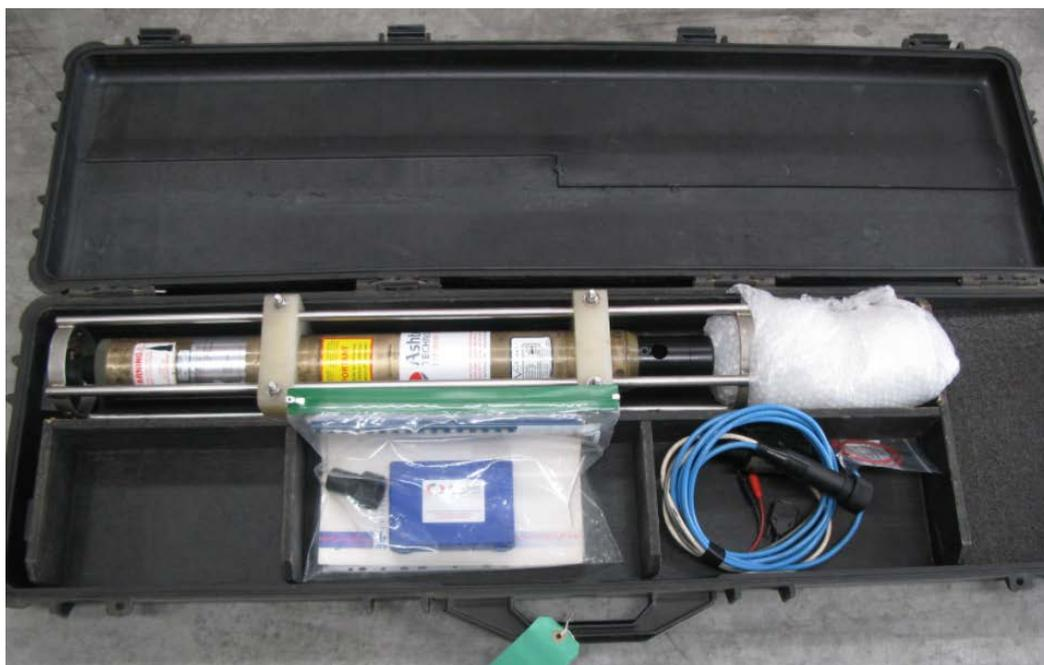
Fig. 4 - Sonda multiparametrica (CTD).
