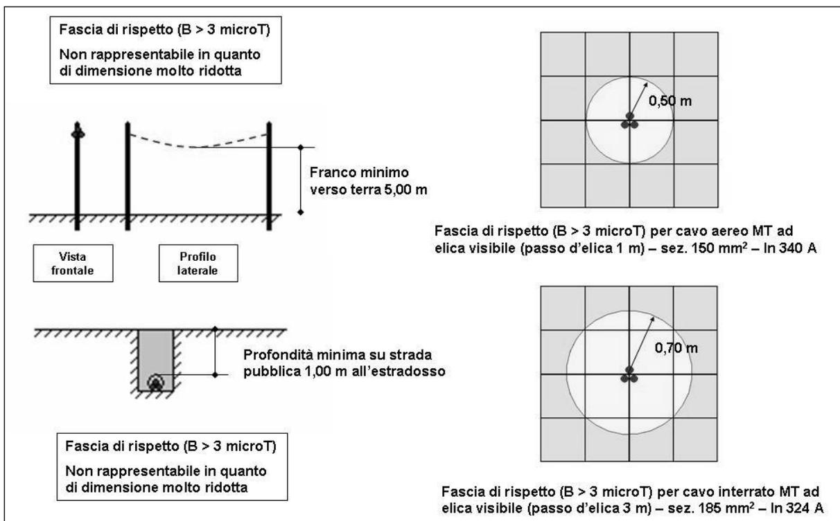
**Figura 1 – Curve di livello dell'induzione magnetica generata da cavi cordati ad elica**
