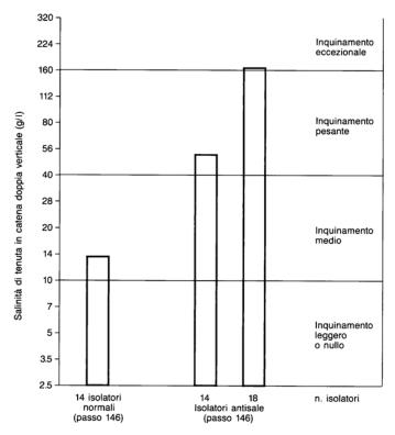
Le caratteristiche della zona interessata dall'elettrodotto in esame sono di inquinamento atmosferico leggero e quindi si è scelta la soluzione dei 14 isolatori (passo 146 mm) tipo J1/2(normali) per tutti gli armamenti in sospensione e quella dei 14 isolatori (passo 146 mm) tipo J1/2(normali) per gli armamenti in amarro.
