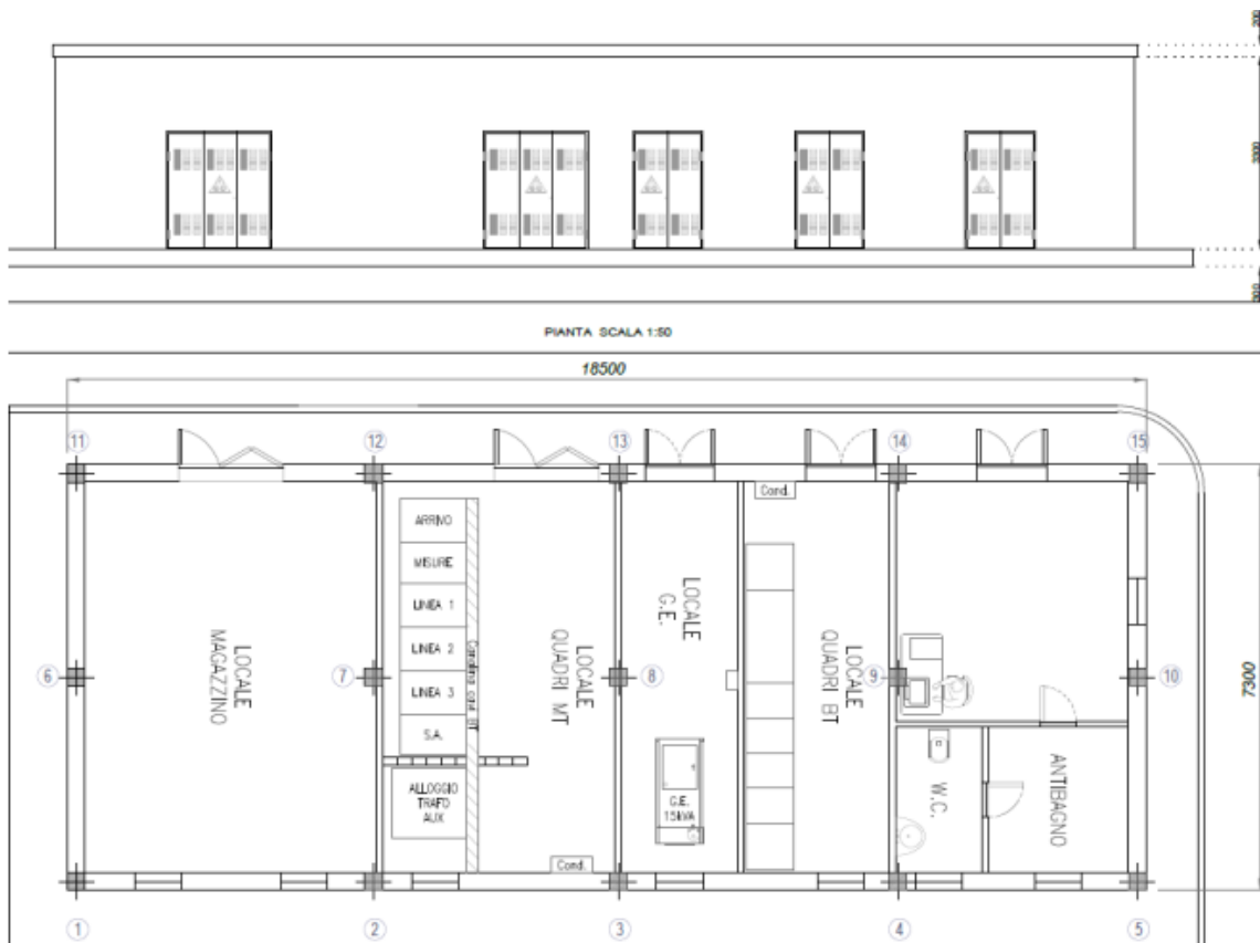
Figura 15. Cabina di sottostazione utente
