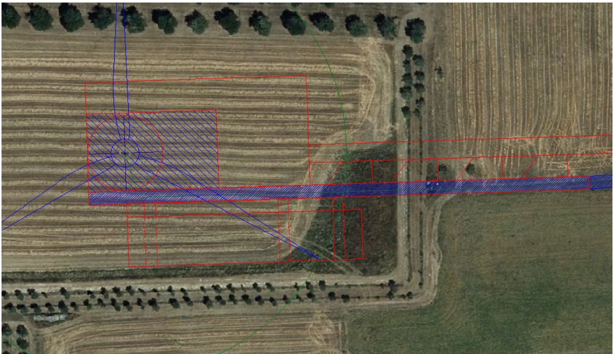
Espianti n.2 ulivi ingresso est area piazzola WTG S03 Gli ulivi saranno reimpiantati nell'ambito della stessa area
