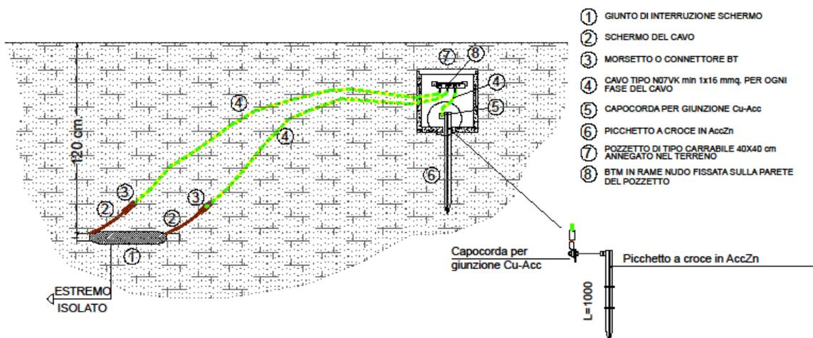
Inoltre in corrispondenza dell'ultimo giunto prima della SSE verrà eseguito l'interruzione dello schermo dei cavi come in figura.
