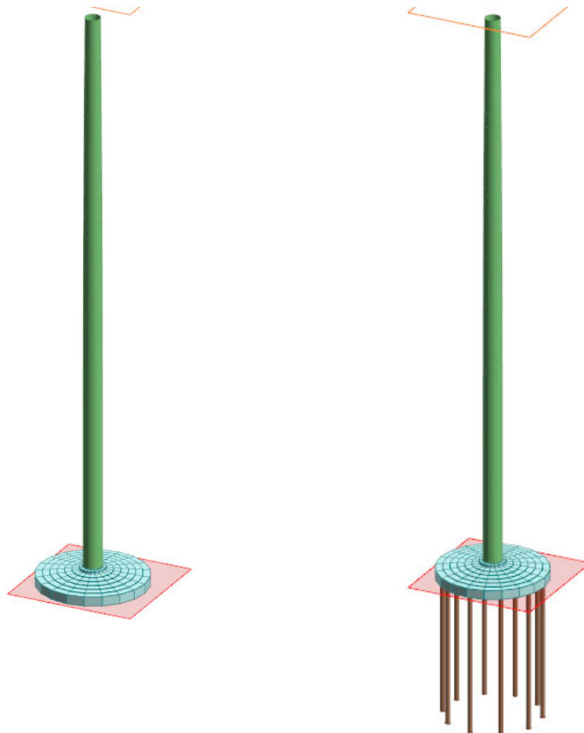
FIGURA 7: MODELLO SOLIDO DEL COMPLESSO TORRE IN ACCIAIO / BLOCCO DI FONDAZIONE CASO SOLO PLATEA E CASO PLATEA CON PALI
