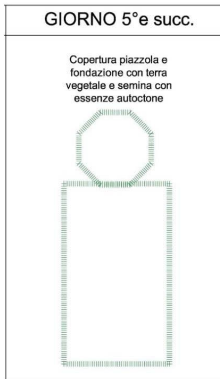
Fasi di smontaggio degli aerogeneratori
