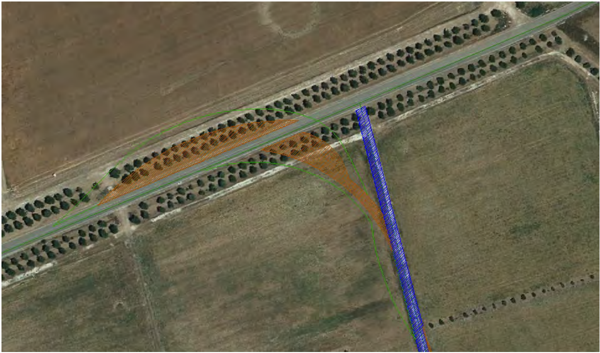
Espianti ulivi area di manovra curva da SP107 direzione WTG S02 Gli ulivi saranno reimpiantati nell'ambito della stessa area
