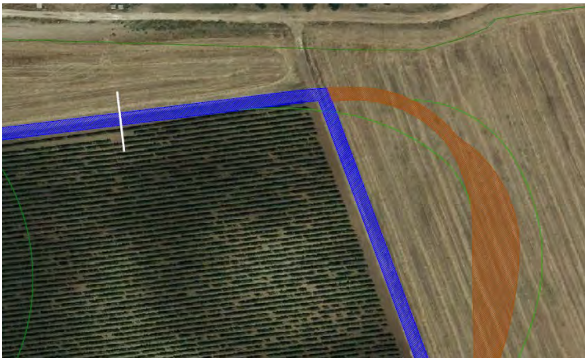
Espianti 100 mq di vigneto per strada ingresso WTG S09 Il vigneto sarà reimpiantati nell'ambito della stessa area a fine cantiere
