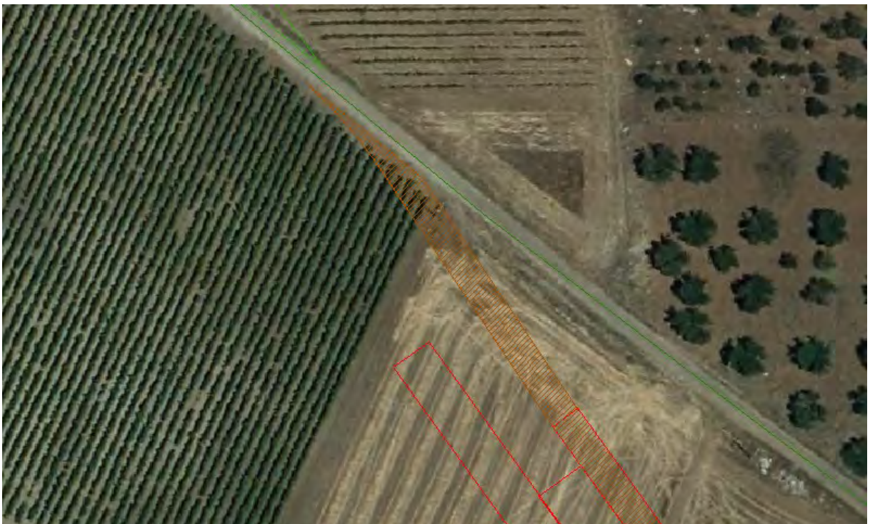
Espianti n.11 alberi di ulivo per ingresso area piazzola WTG S05 Il vigneto sara' reimpiantato con la stessa configurazione a fine cantiere.
