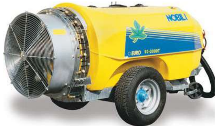
Figure 7-49. Esempi di turboatomizzatore trainato per trattamenti del mandorleto
