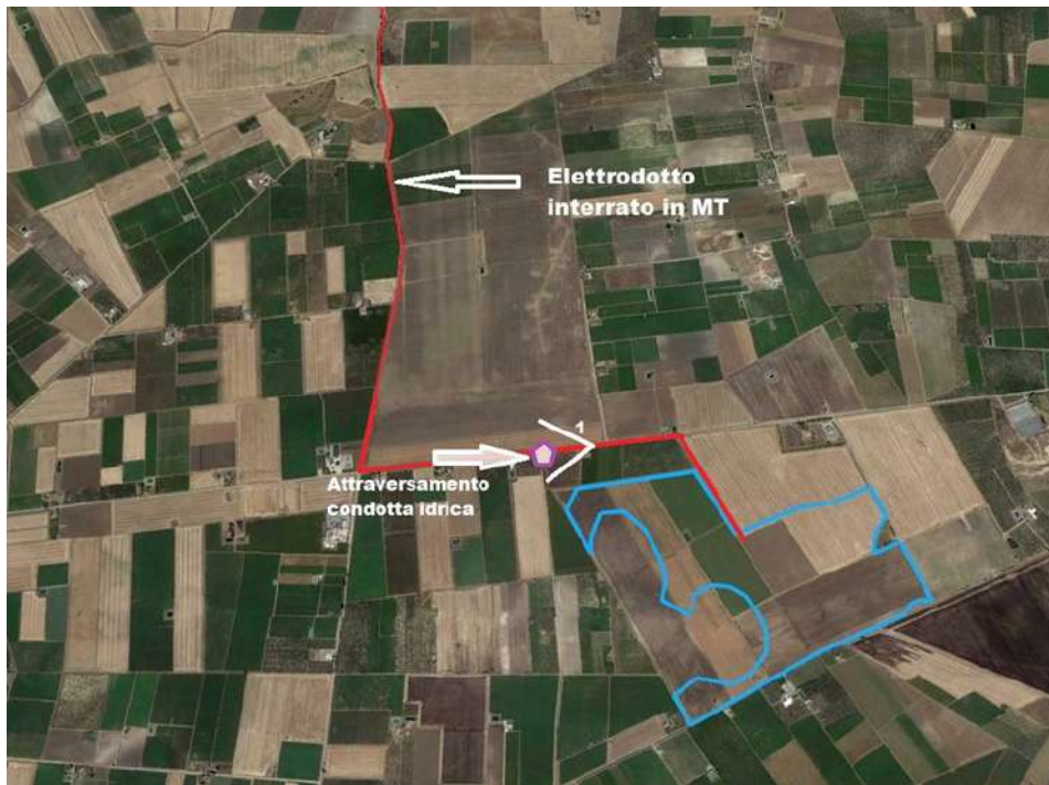
Figure 3-9. Planimetria di dettaglio n. 1 con principali interferenze
