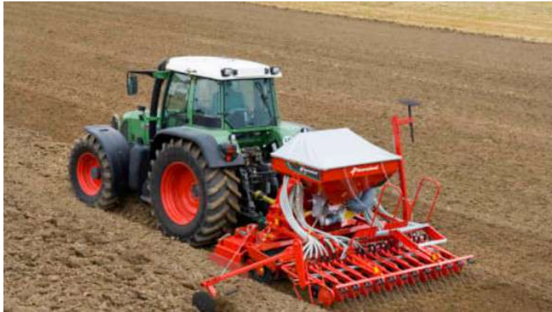
Figure 7-52. Esempio di seminatrice pneumatica per tutte le tipologie di sementi.
