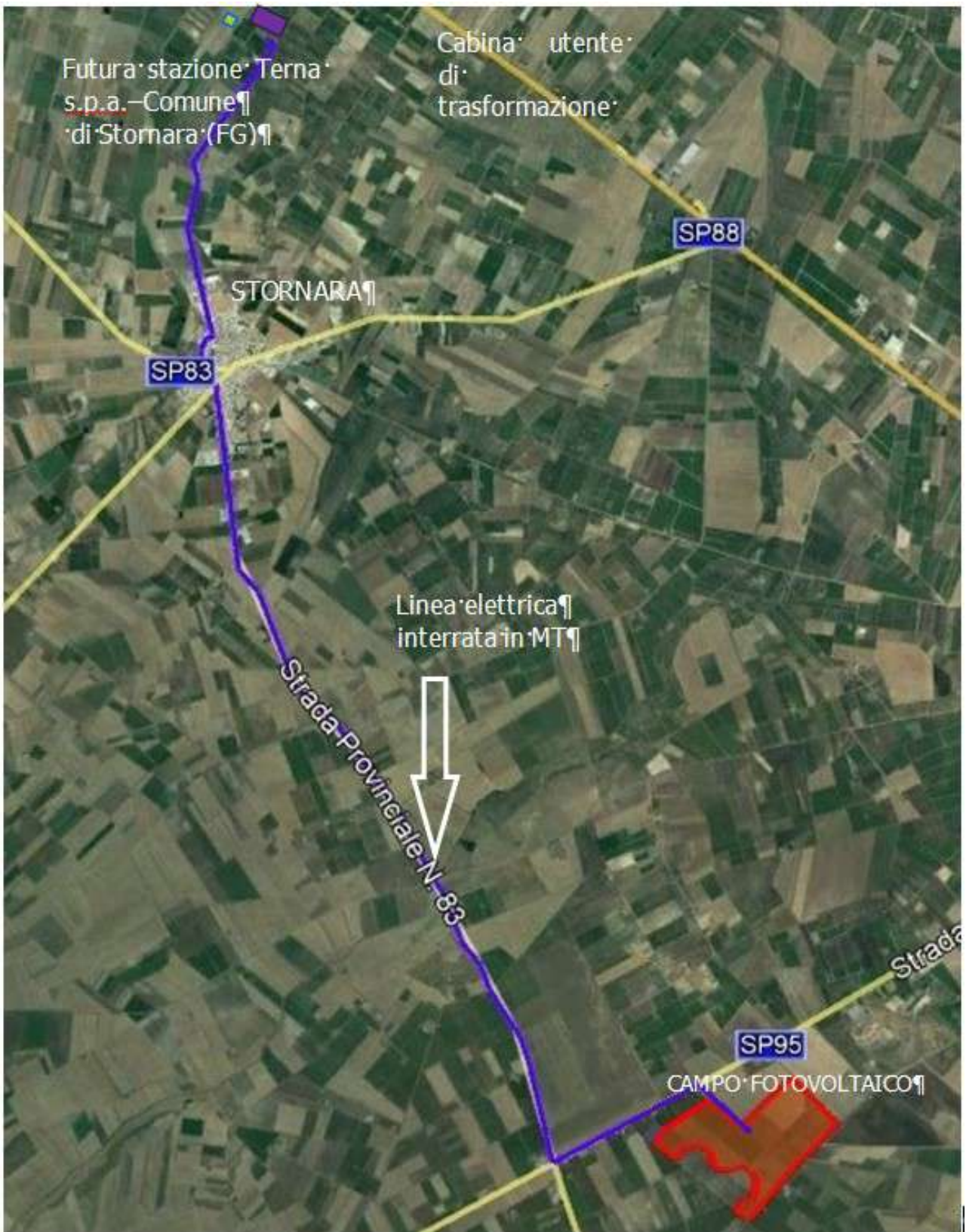
Figure 3-5. Vista d'insieme dell'impianto con collegamento cavo MT (in blu)
