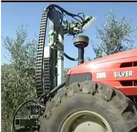
Figure 7-48. Esempio di potatrice meccanica frontale a doppia barra (taglio verticale + topping) utilizzabile su tutti le colture arboree intensive e superintensive.
