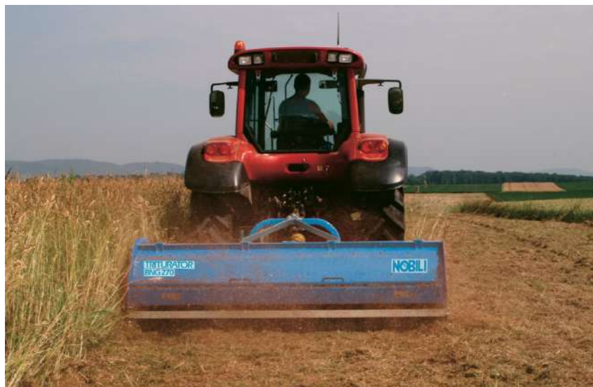
Figure 7-53. Esempio di trincia posteriore.
