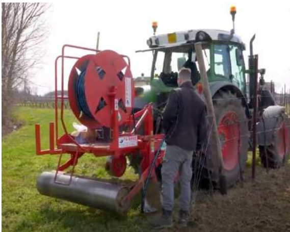
Figure 7-51. Posa ala gocciolante per impianto di sub-irrigazione.
