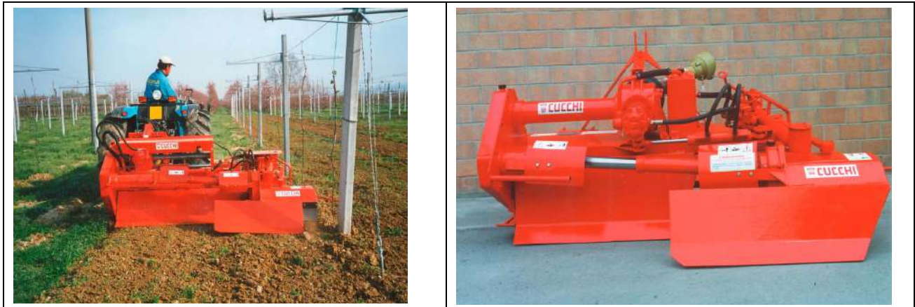
Figura 7-12. Esempio di fresatrice interceppo per le lavorazioni sulla fila
