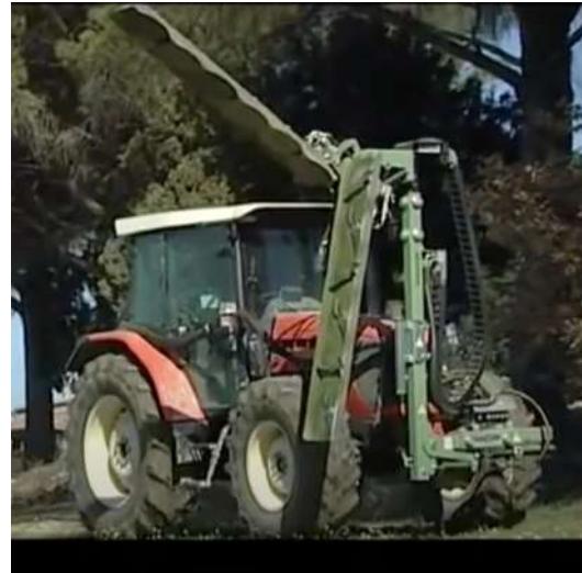
Figure 7-48. Esempio di potatrice meccanica frontale a doppia barra (taglio verticale + topping) utilizzabile su tutti le colture arboree intensive e superintensive.
