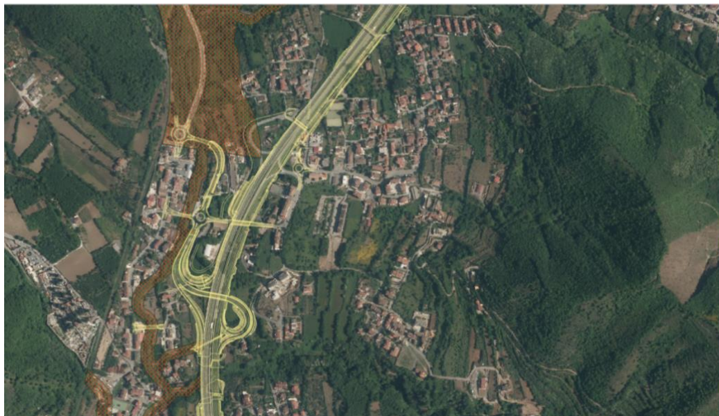
Figura 2 – Interferenze dirette della viabilità di progetto con il sito ZSC/ZPS IT8050056 Fiume Irno in corrispondenza dello svincolo di Baronissi
