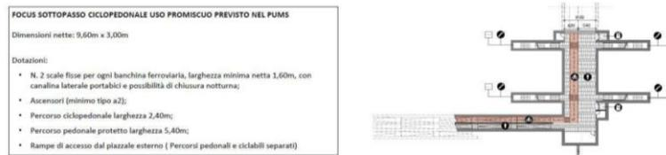
Figura 7 - Planimetria di sottopasso di fermata
