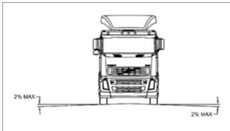
Figura 18. Illustrazioni prese dal "Wind farm Roads Requirements" della Vestas, relative alla pendenza longitudinale (a) e alla pendenza laterale della carreggiata (b).
