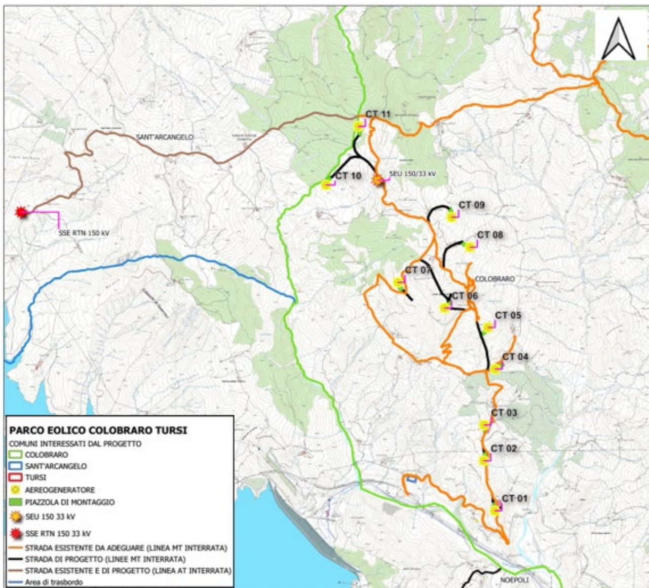
Figura 5: Layout d'impianto zona 1 su CTR
