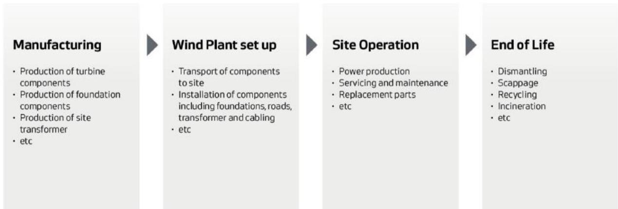
**Figura 1 – Fasi del ciclo di vita di un impianto eolico**
