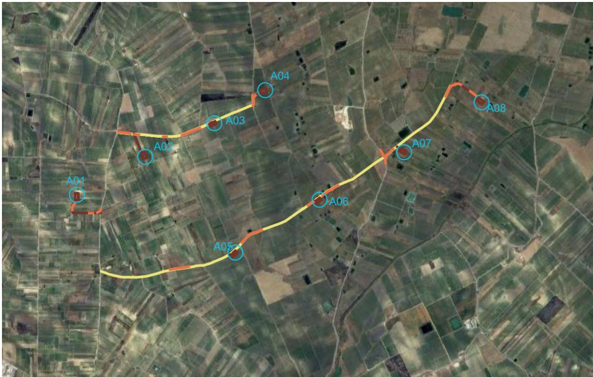
Figura 3: realizzazione di filari alberati lungo la viabilità interna al campo – in arancione i filari di alberi; in giallo la viabilità esistente da adeguare; in marrone le strade e piazzole di progetto
