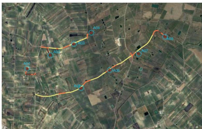
**Figura 26: realizzazione di filari alberati lungo la viabilità interna al campo – in arancione i filari di alberi; in giallo la viabilità esistente da adeguare; in marrone le strade e piazzole di progetto**
