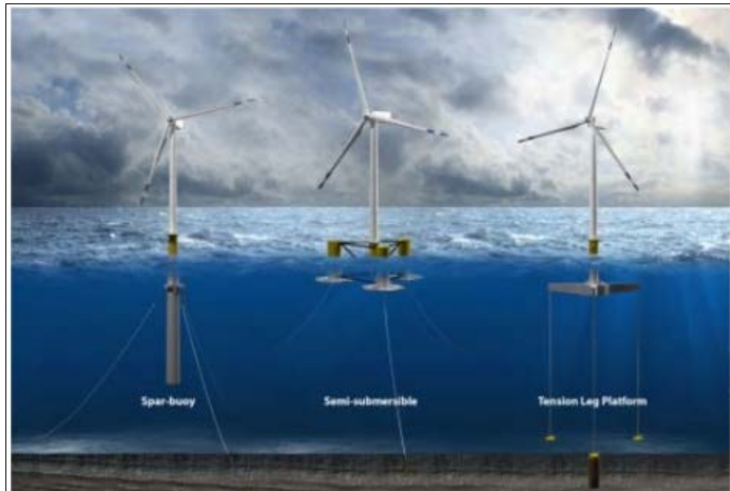
Fig. 8 - Sistemi di ancoraggio
