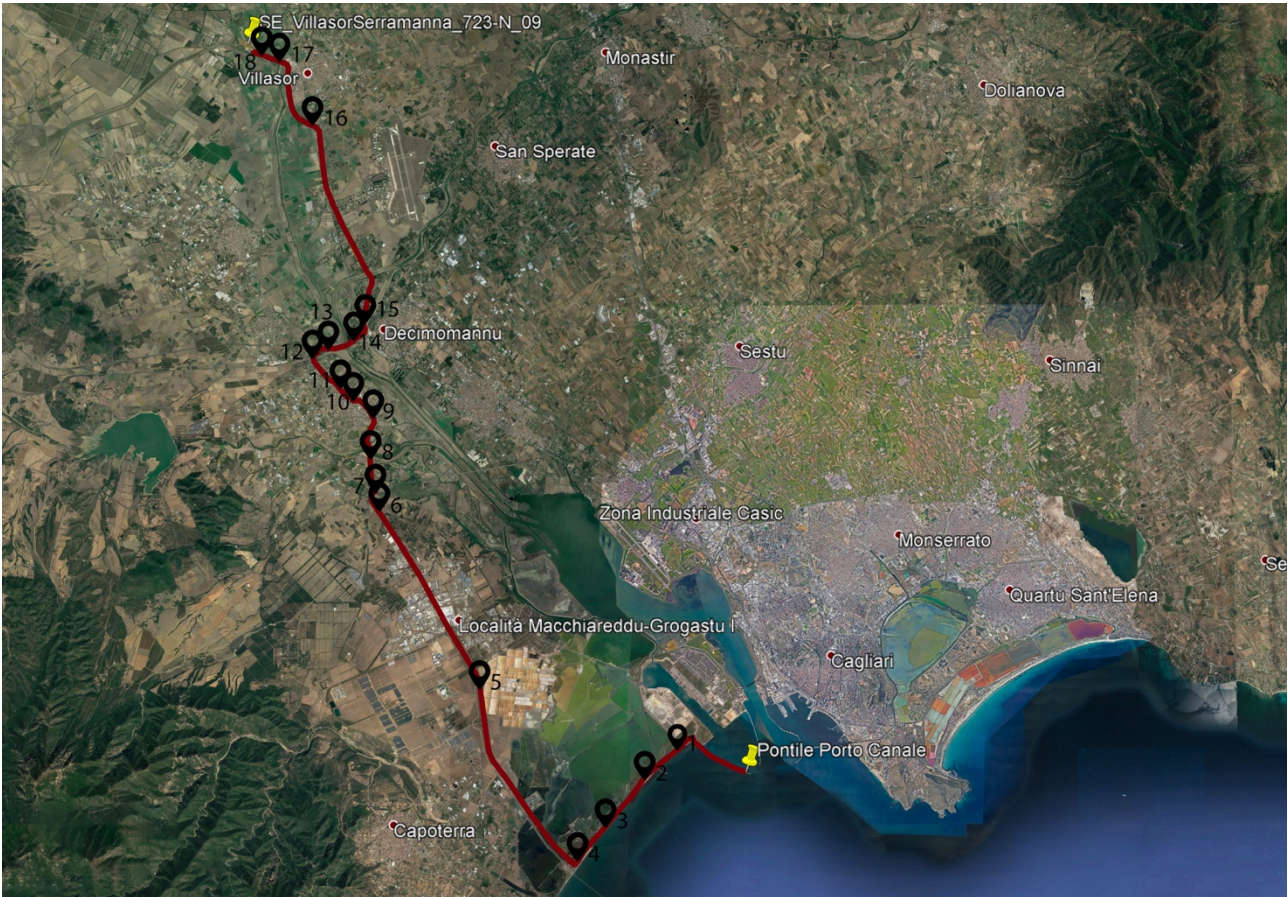
Percorso del cavo a terra dal punto di sbarco sul Pontile Porto Canale fino alla centrale di consegna SE_Villasor.
