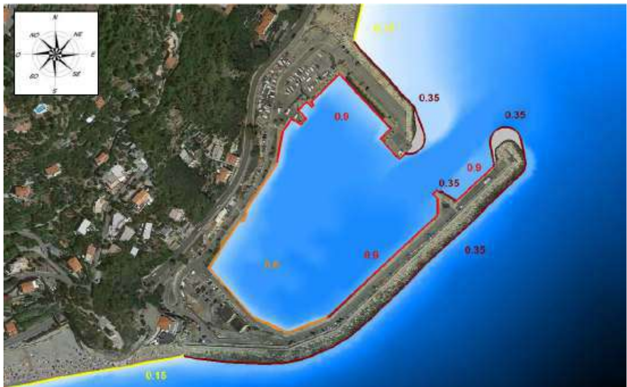
Coefficienti di riflessione impiegati nello studio dell'agitazione ondosa Ipotesi progetto 2 – Fase 2
