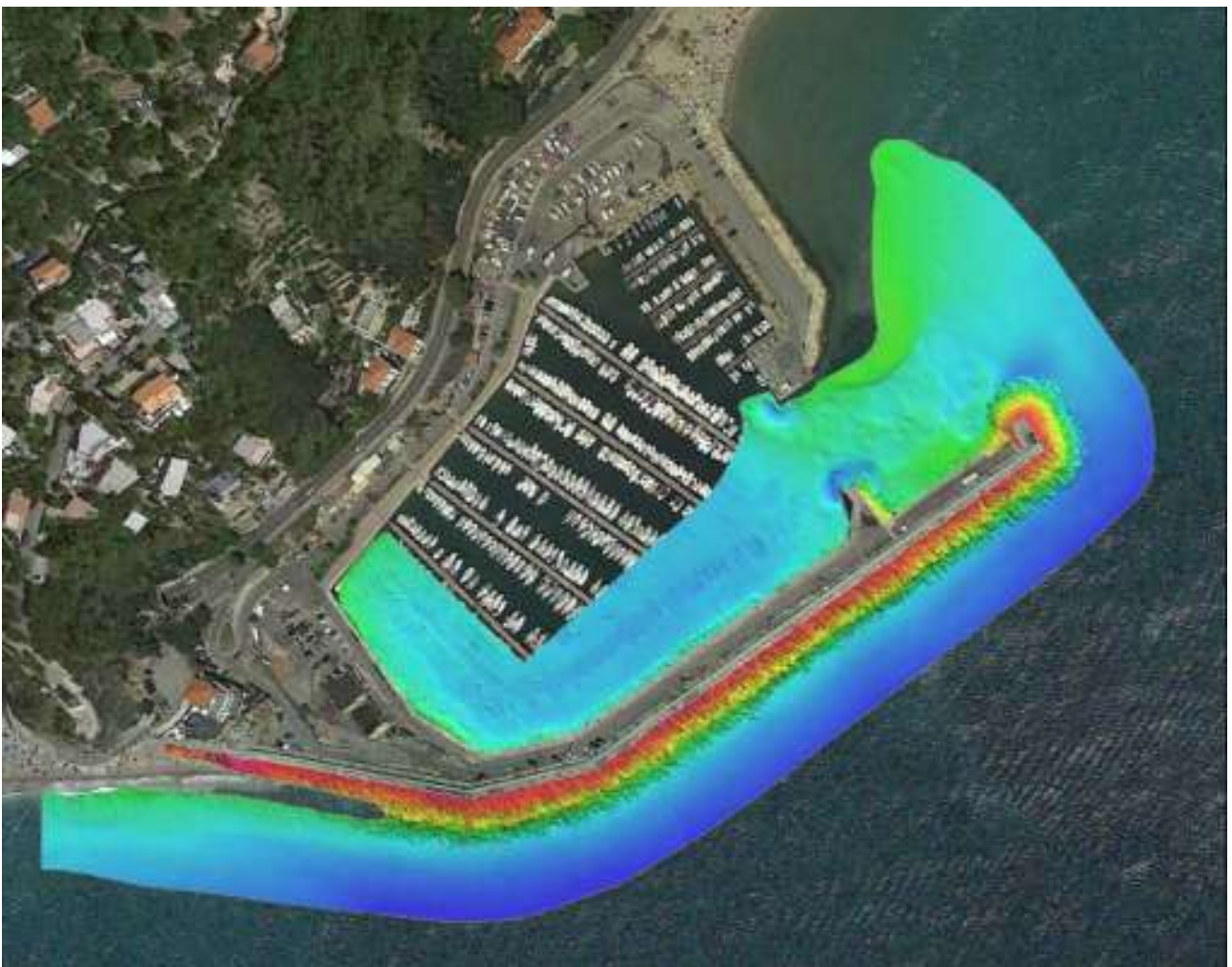
DTM del rilievo multibeam su immagine satellitare
