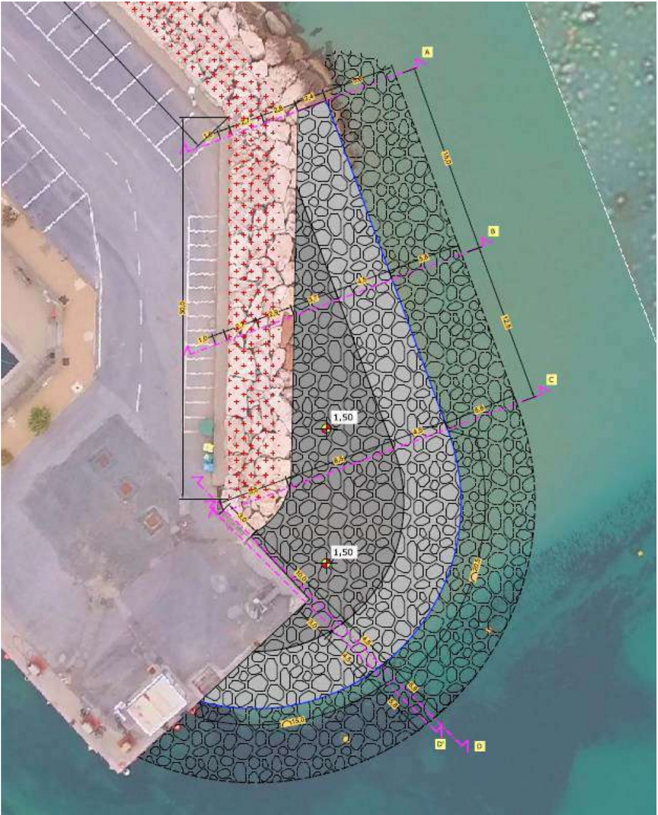
Progetto della berma del ringrosso con indicate le sezioni di progetto
