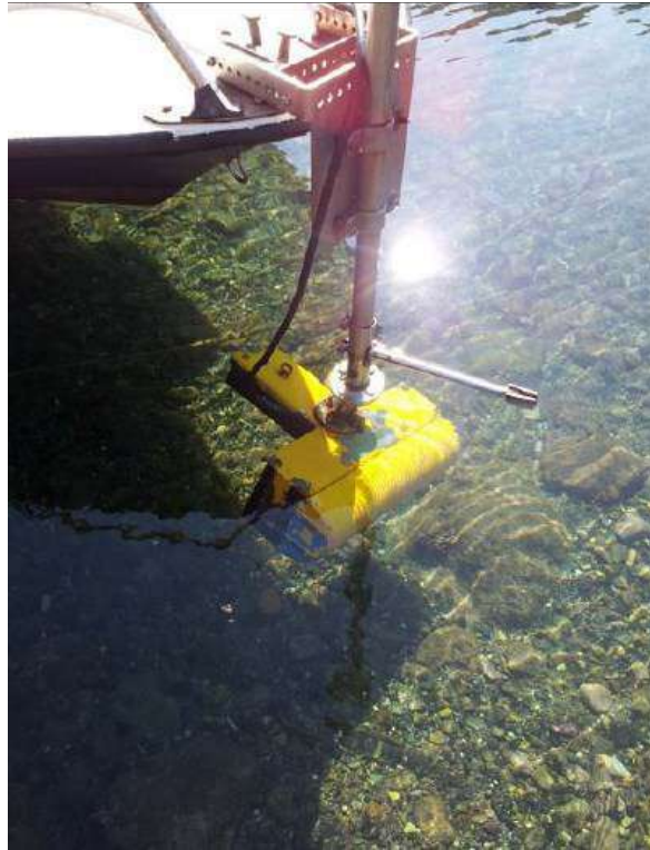
Dettaglio del trasduttore inclinato a 25° lato dritta
