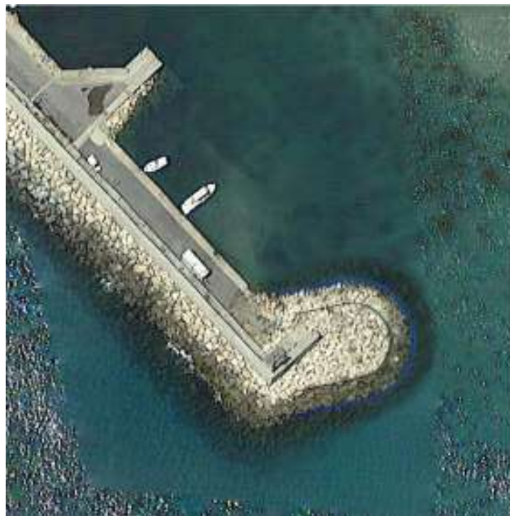
Fotoinserimento progettuale relativo al ringrosso della testata del molo foraneo (molo di sopraflutto), in via di esecuzione
