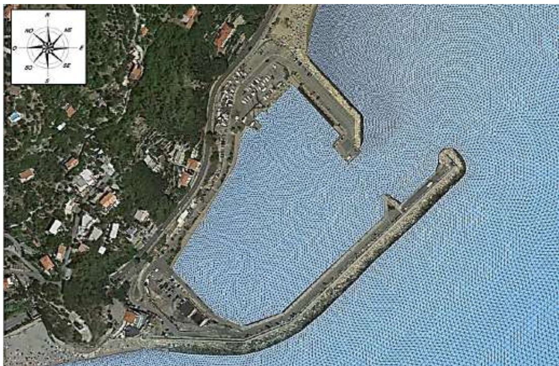
Particolare della mesh di calcolo in prossimità e all'interno del porto – Configurazione attuale
