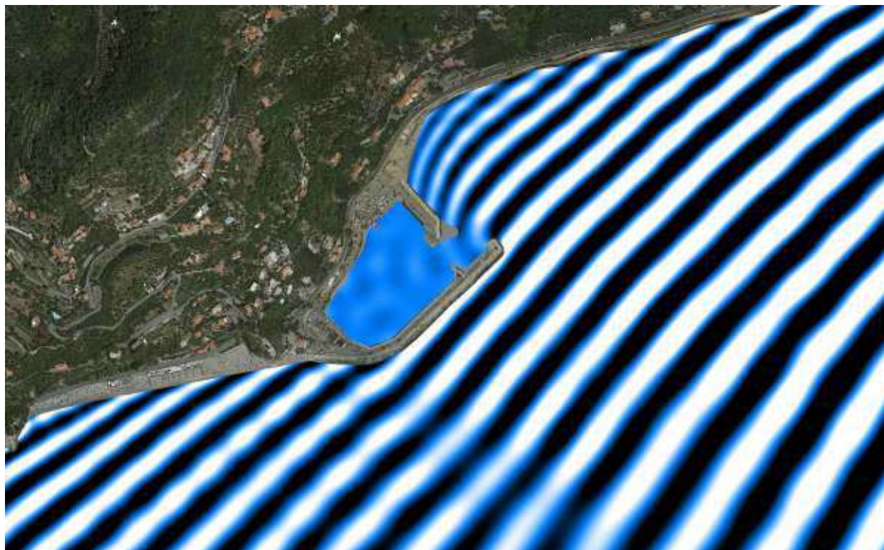
TEST 3: mareggiata severa da ESE ( T_P = 10 s, DIR = 110^\circ N ), andamento delle creste
