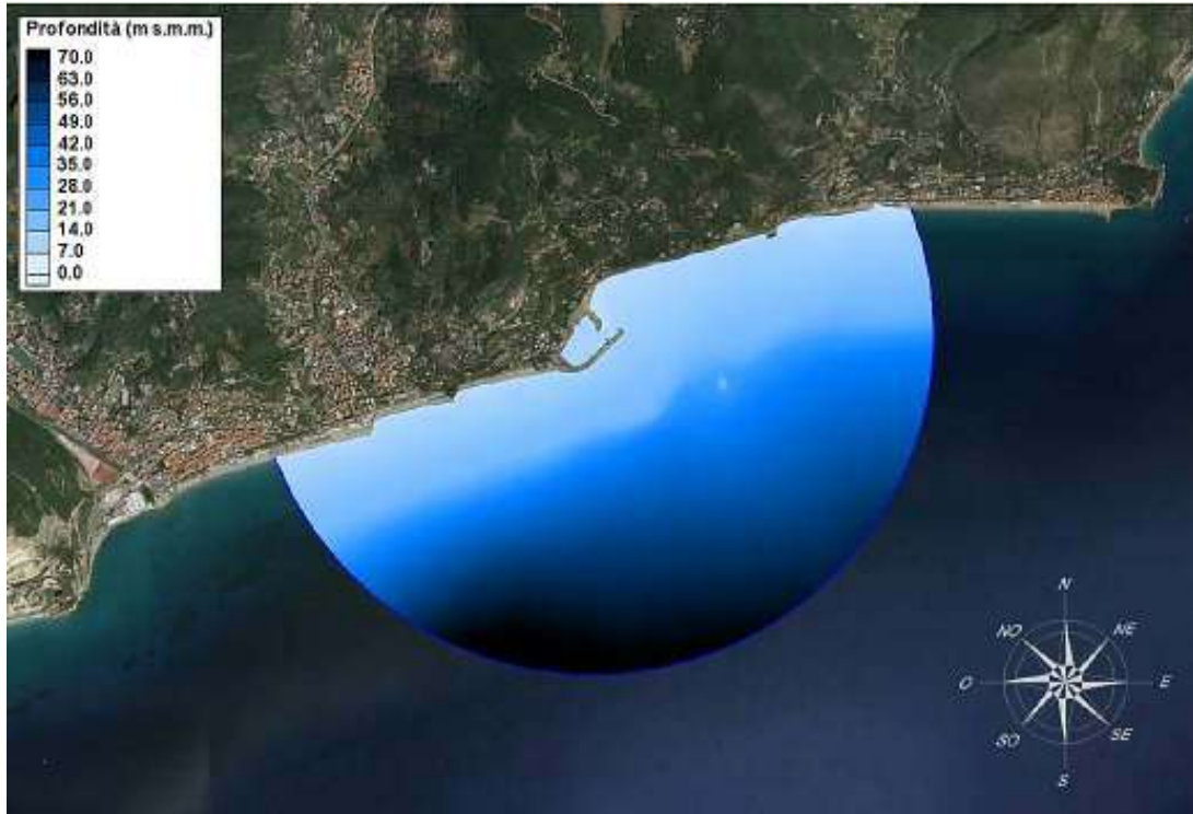
Dominio di calcolo impiegato nello studio della penetrazione del moto ondoso
