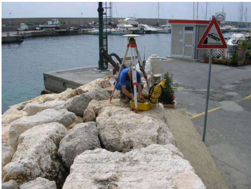
Posizionamento della GPS reference station
