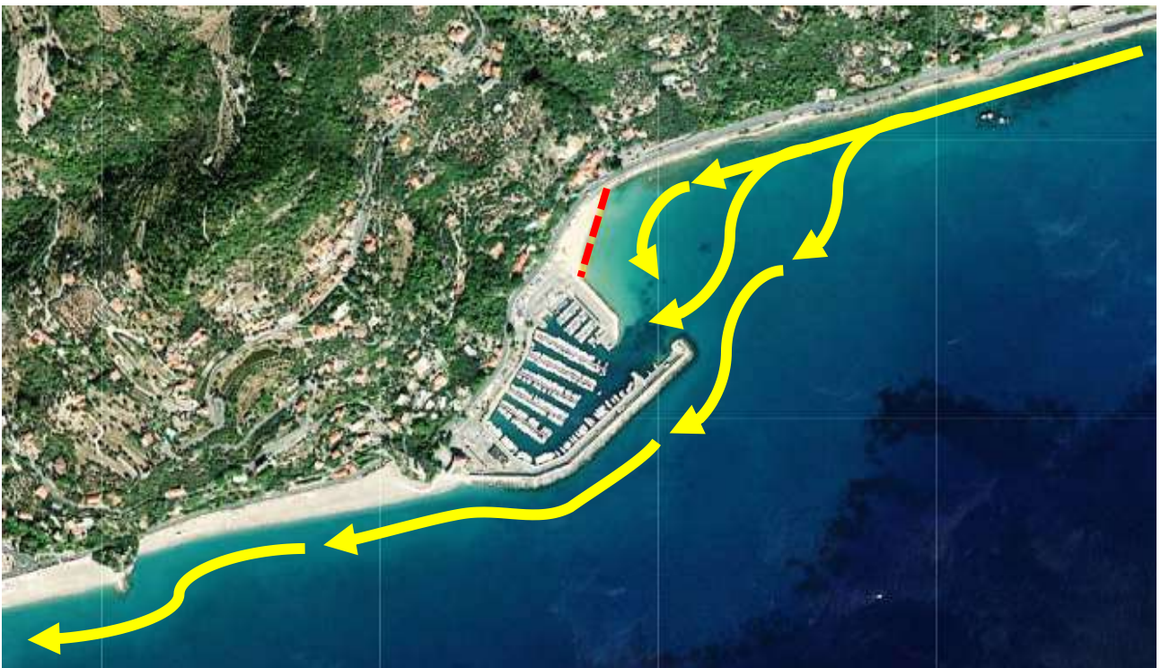
In rosso il tratto dell'arenile a levante del porto, lungo 142 m, in giallo le correnti dominanti di deposizione sabbiosa, causa dell'insabbiamento del porto e della formazione dell'arenile stesso. Si nota davanti all'arenile la forte deposizione sabbiosa finì alla testata di sottoflutto (zona chiara) mentre la zona più scura all'imboccatura è dovuta al dragaggio portuale.
