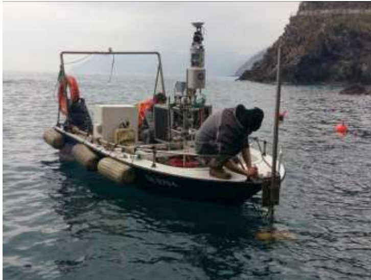
Foto dell'intero sistema MBES montato sull'imbarcazione "ECHO 1, dettaglio ecoscandaglio multifascia, Laser Scanner, e ricevitore GPS
