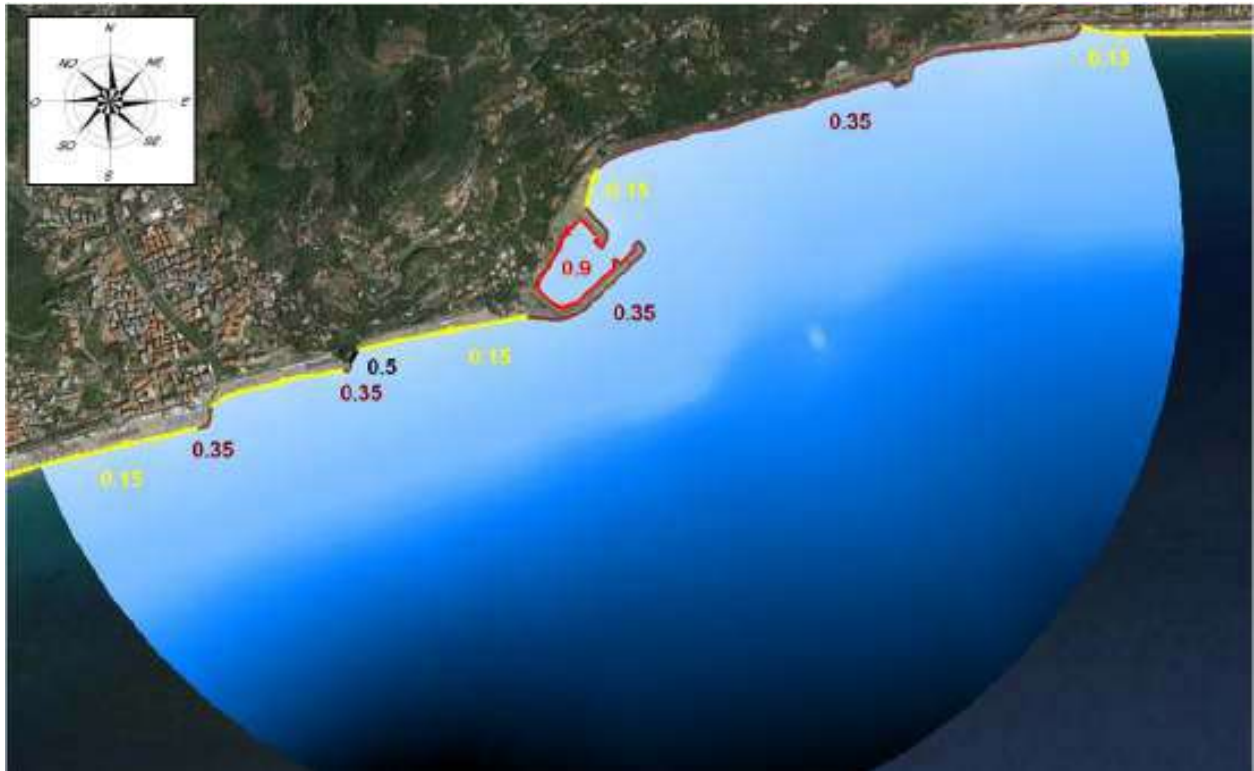
Coefficienti di riflessione impiegati nello studio dell'agitazione ondosa – Configurazione attuale
