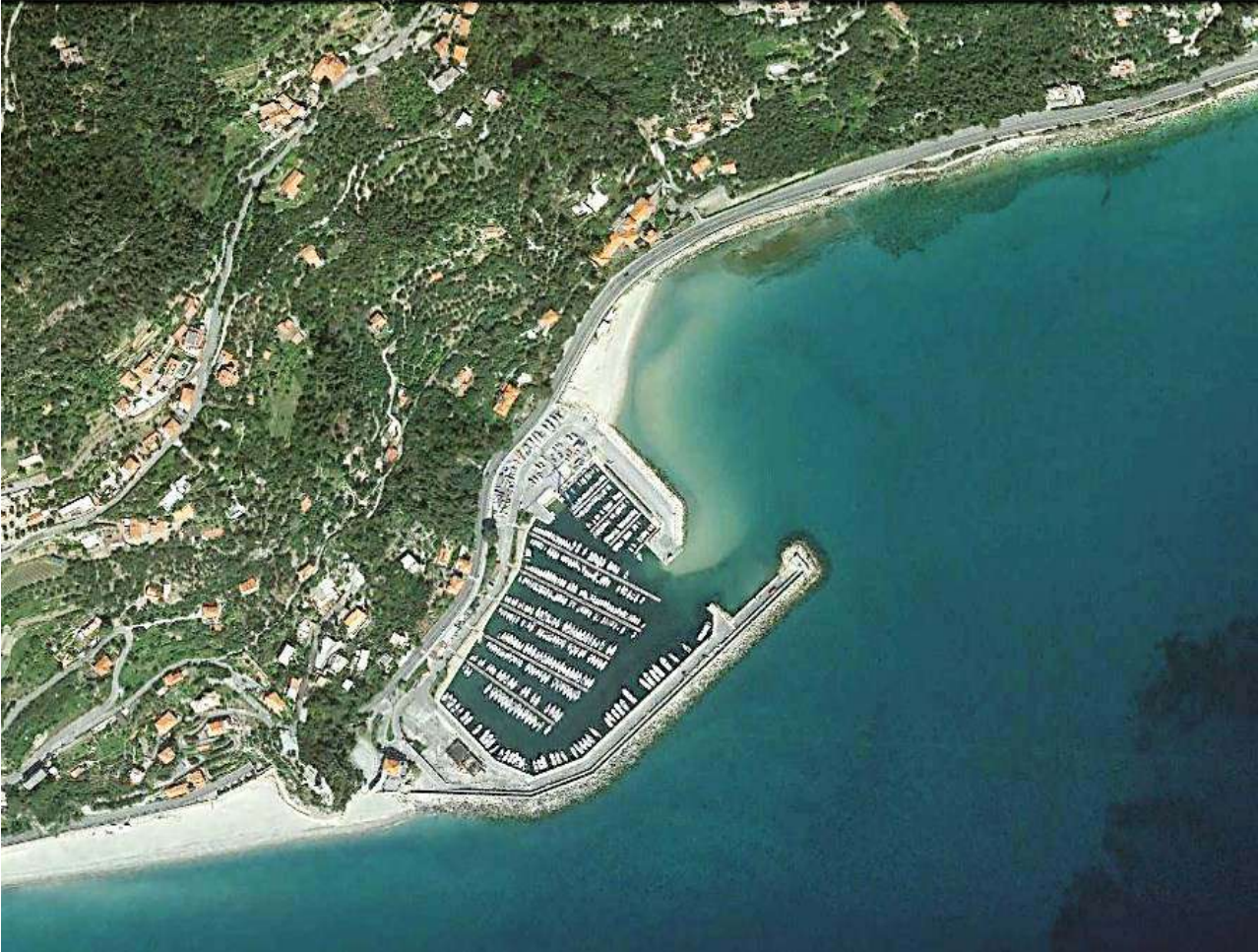
Movimento sedimentario che lambisce la spiaggia per poi estendersi fino al molo di sottoflutto
