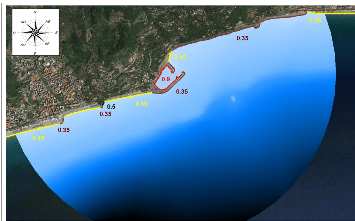
Fig. 6.4 – Coefficienti di riflessione impiegati nello studio dell'agitazione ondosa – Configurazione attuale
