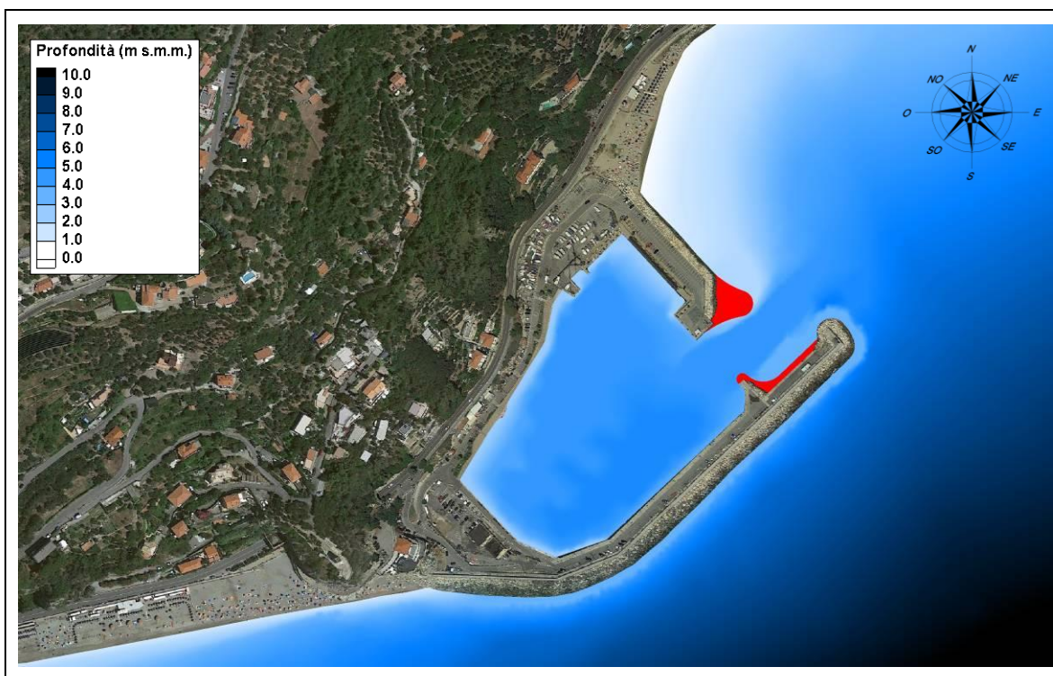
Fig. 5.3 – Layout del porto nell'ipotesi di progetto 1
