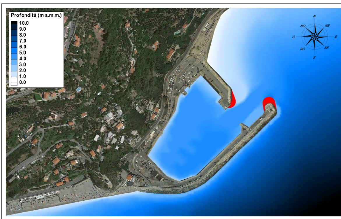
Fig. 5.4 – Layout del porto nell'ipotesi di progetto 2
