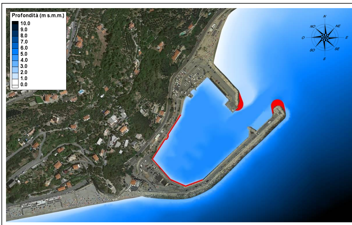
Fig. 5.5 – Layout del porto nell'ipotesi di progetto 2 – Fase 2
