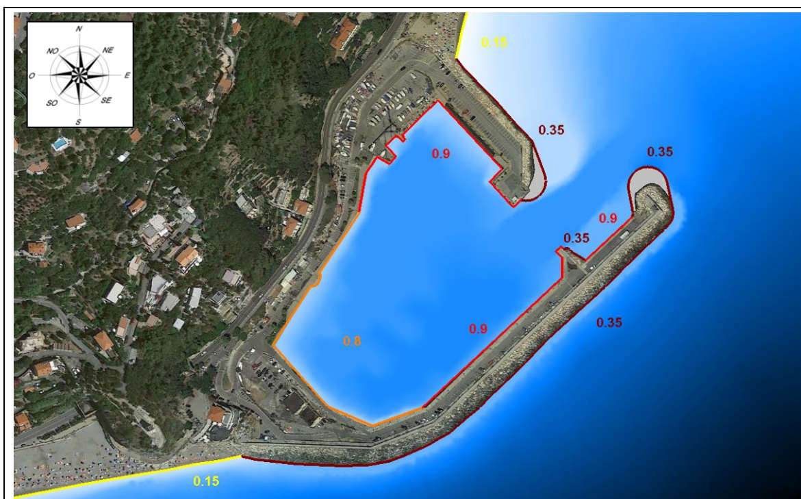
Fig. 6.5 – Coefficienti di riflessione impiegati nello studio dell'agitazione ondosa ipotesi progetto 2 – Fase 2
